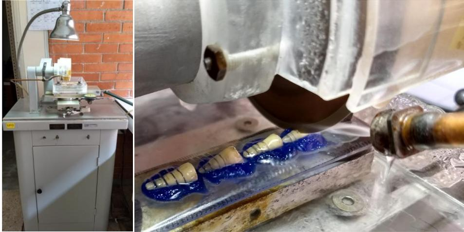
**Fig. 46 Recortadora con irrigación. Fuente directa.**
