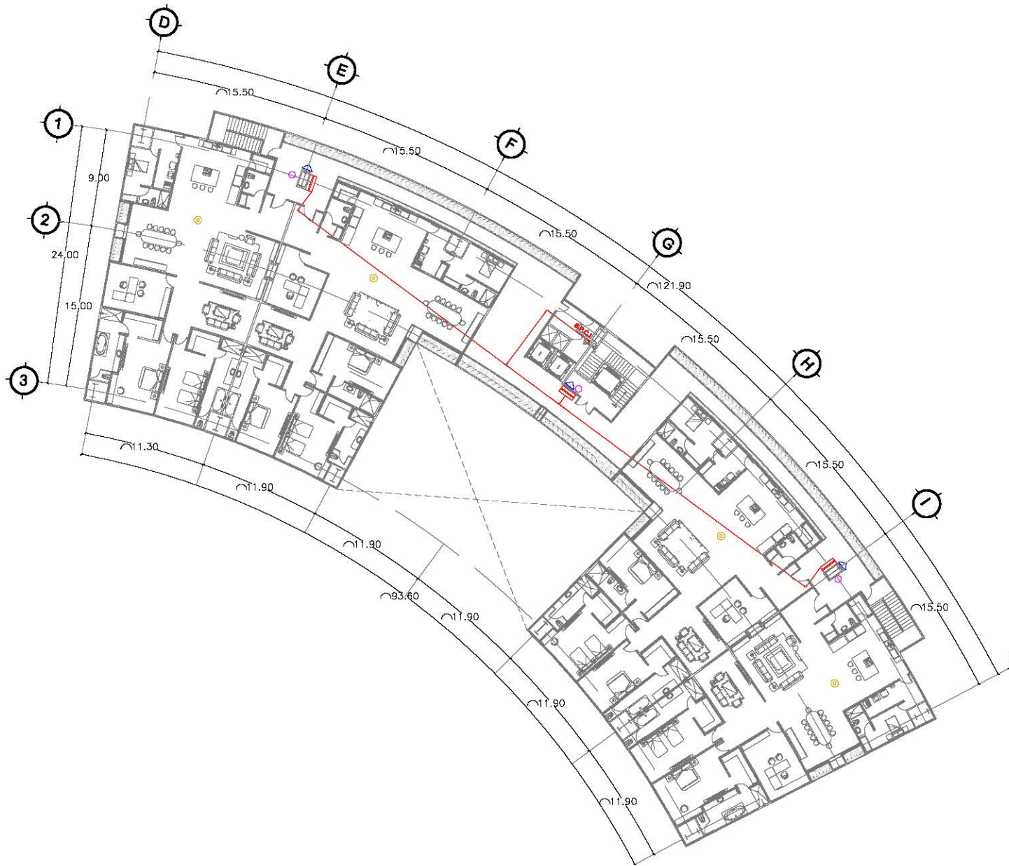
INSTALACIÓN SISTEMA CI DEPARTAMENTOS NIVEL 5-12
