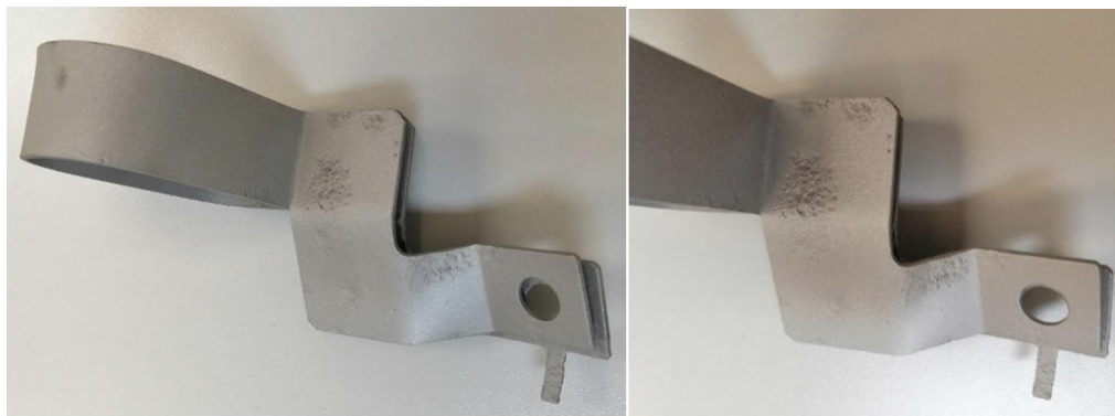
Figura 6. 15 Remoción de productos de corrosión al terminar prueba de corrosión cíclica
