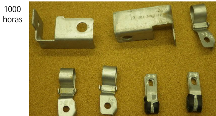
Figura 6. 18 Pintura rica en cinc (“Delta protekt KI-120 + VH340”) – niebla salina
