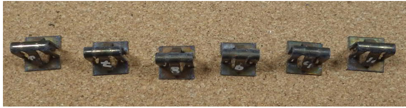
Figura 6. 11 Cinc electrodepositado (Termax) – 95 ciclos
