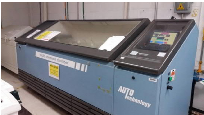
Figura 5. 2 Cámara para prueba de corrosión cíclica [8]
