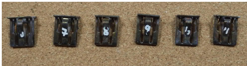
Figura 6. 10 Pintura rica en cinc 3 (“Delta protekt KI-120 + VH340”) – 95 ciclos
