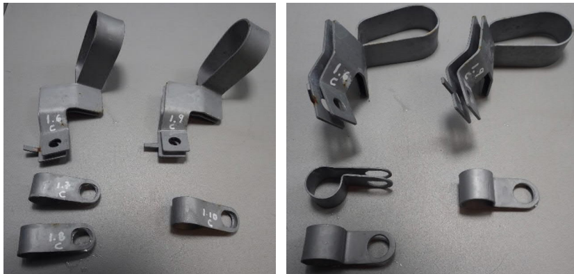
Figura 6. 1 Pintura rica en cinc 1 (“Delta protekt Kl-120 + VH301.1 GZ”) – 6 ciclos
