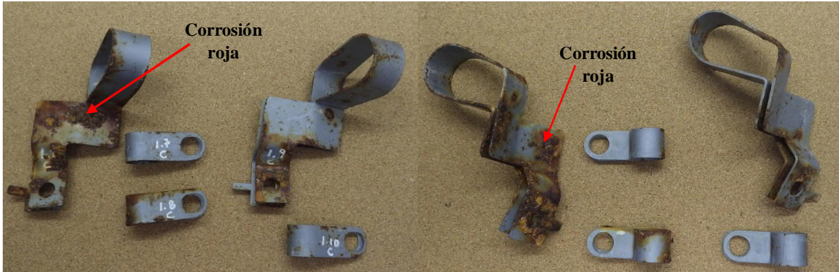
Figura 6. 8 Pintura rica en cinc 1 (“Delta protekt KI-120 + VH301.1 GZ”) – 95 ciclos
