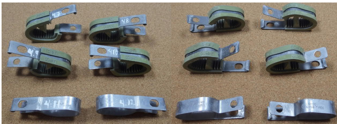
Figura 6. 13 Aleación de Zn-Ni más sellador inorgánico (Zn-Ni + “Deltacoll 80 farblos”) – 95 ciclos
