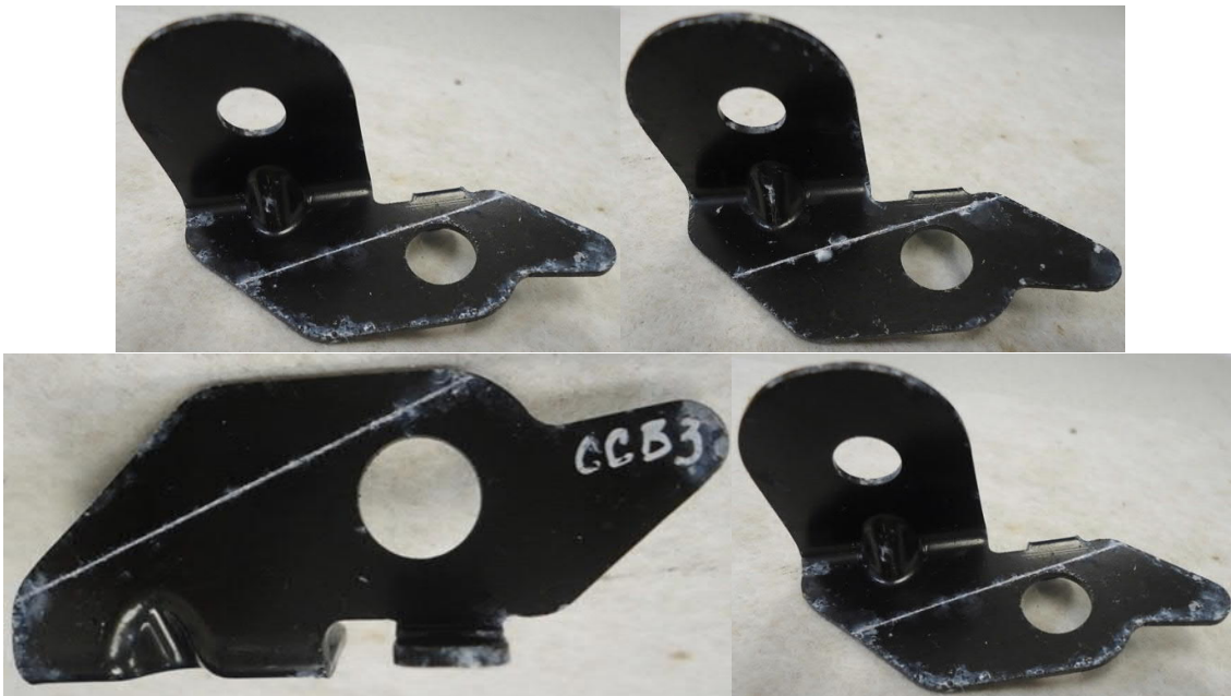
Figura 6. 22 Pintura electroforética – niebla salina
