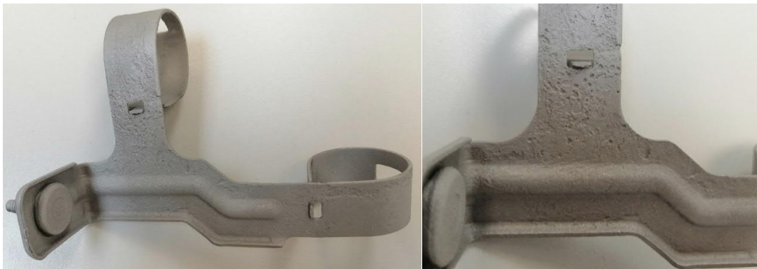
Figura 6. 23 Remoción de productos de corrosión al final de niebla salina
