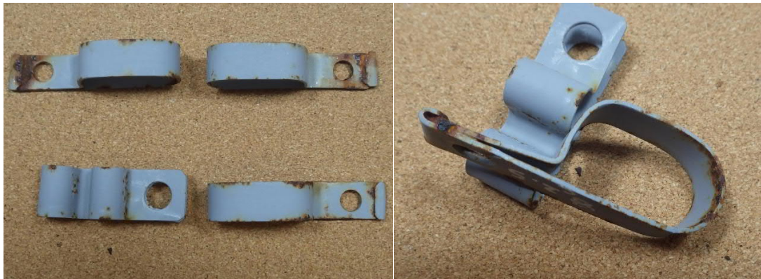
Figura 6. 9 Pintura rica en cinc 2 (“Delta protekt KI-120 + Delta seal HC light grey”) – 95 ciclos
