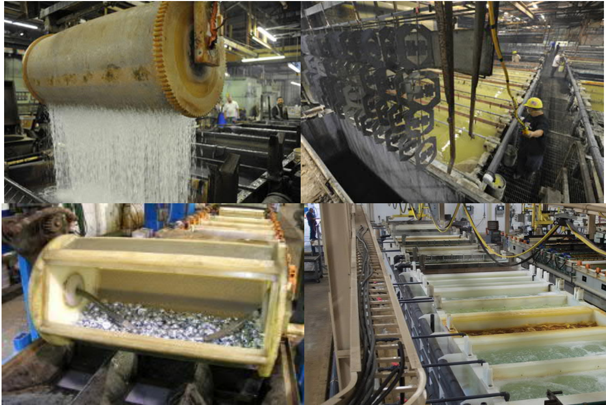
Figura 3. 14 Proceso de aplicación de cinc electro-galvanizado [16]
