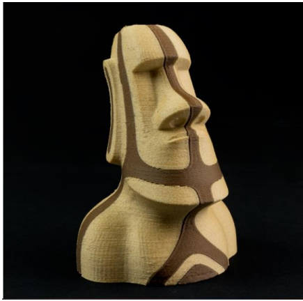
Figura A1. Busto fabricado en filamento plástico con partículas de madera. Fuente: [2]
