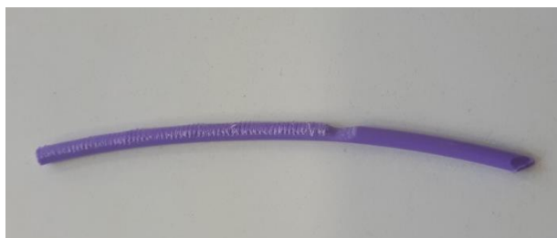
Figura 35. Filamento PLA en color morado con desgaste.
