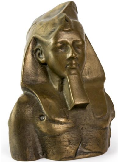
Figura A2. Busto fabricado en filamento plástico con partículas de metal. Fuente: [2]
