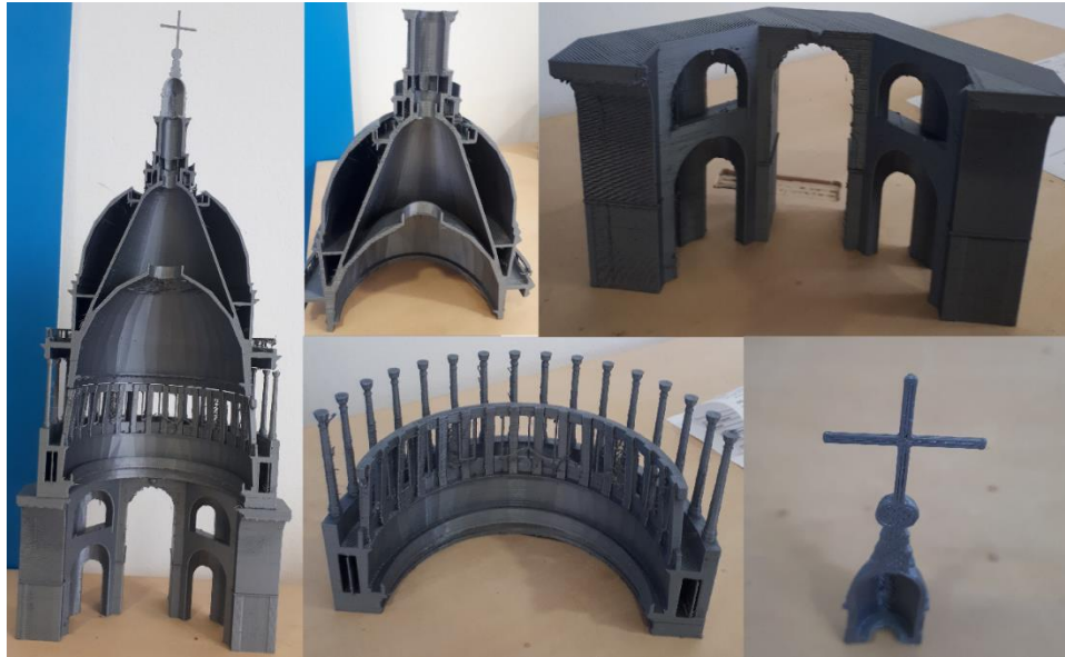
Figura 45. Diseño de cúpula. Pieza segmentada en 4 piezas independientes, en procesos separados, en PLA color plata. Fuente: Espacio de fabricación ETSEIB.
