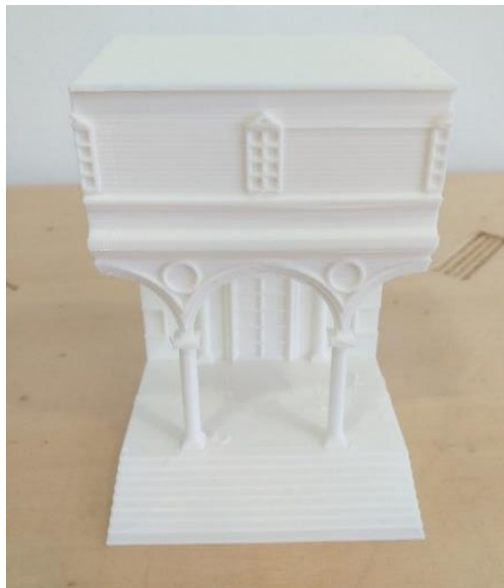
Figura 1. Maqueta arquitectónica en PLA color blanco, fabricada en el espacio de fabricación digital por el proceso de extrusión de material.
