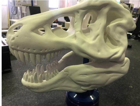
Figura 46. Modelo de un dinosaurio formado por extrusión de PLA, son 7 piezas independientes, aplicando pegado, lijado y pintado bicapa mate. Fuente: Fundación CIM.
