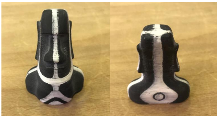
Figura 44. Pieza con lijado, fabricada en ABS color blanco y negro. Fuente: Fundación CIM.
