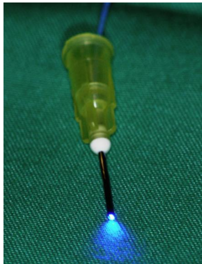
Imagen 24. Microtubo y cable de fibra óptica necesario para la polimerización de la resina. 32
