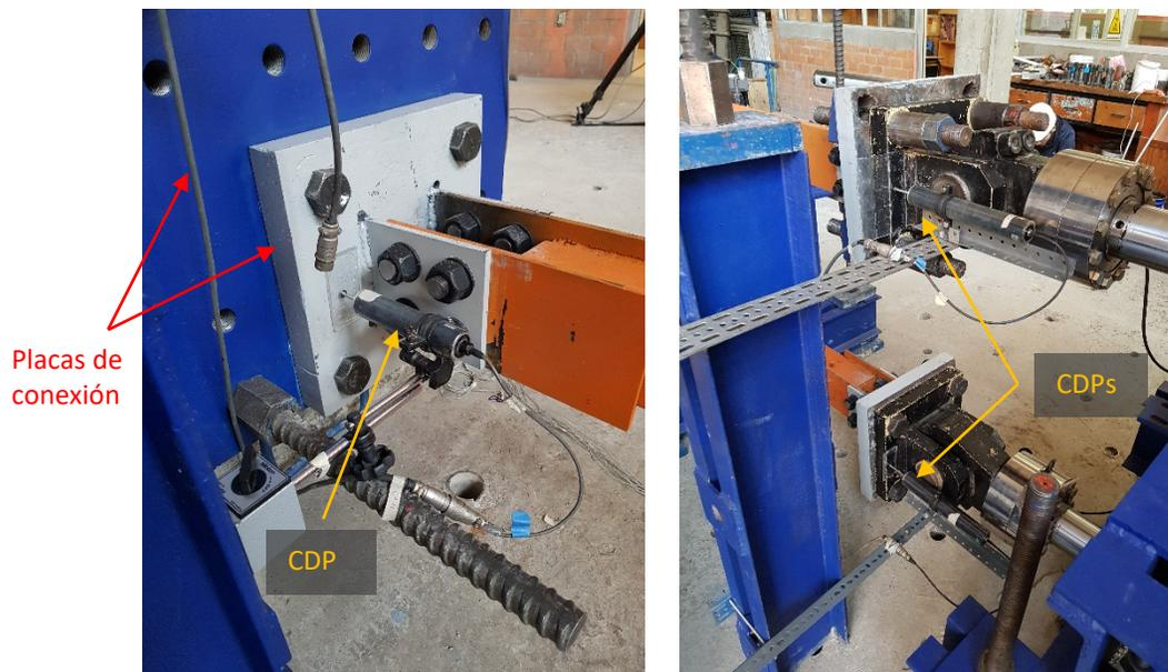
**Figura 22.** Detalle de las placas de conexión y colocación de transductores de desplazamiento.
