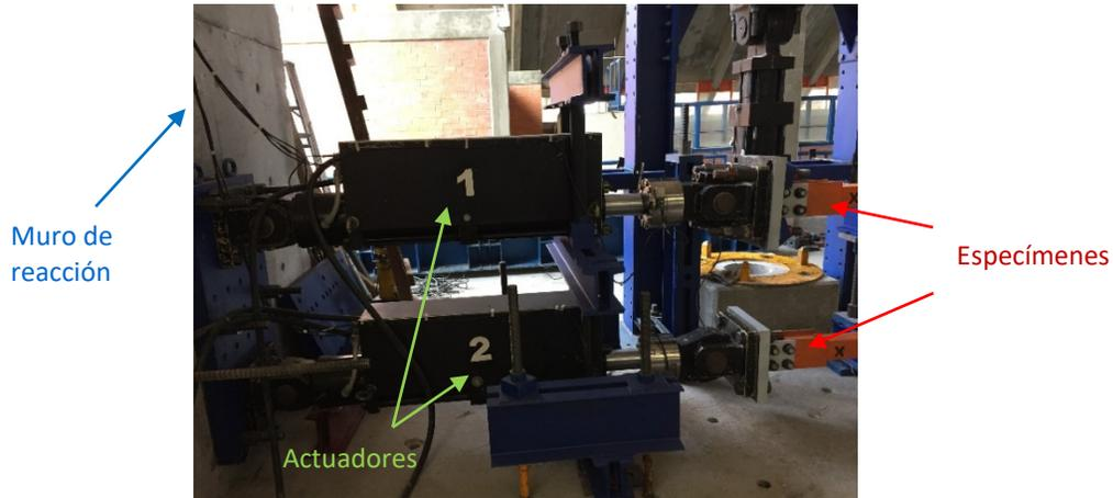
**Figura 17.** Actuadores utilizados durante las pruebas de simulación híbrida.
