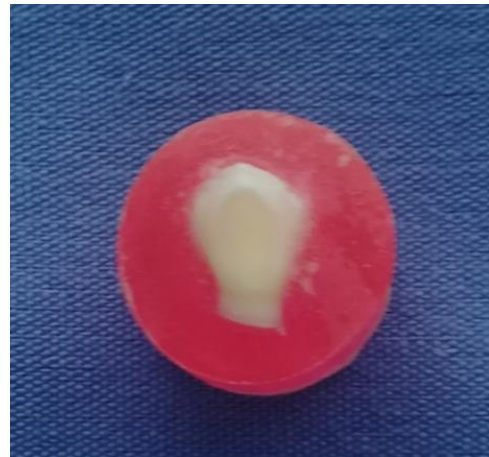
Figs. 20 y 21 Muestras pertenecientes a los grupos de autograbado después de la prueba de resistencia al desprendimiento. FD
