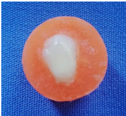
Figs. 20 y 21 Muestras pertenecientes a los grupos de autograbado después de la prueba de resistencia al desprendimiento. FD
