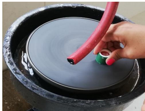
Fig. 9 Desgaste del esmalte con papel de carburo de silicio. FD
