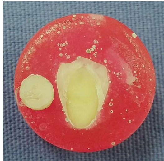
Fig. 26 Muestra de autograbado en dentina, después de la prueba. FD
