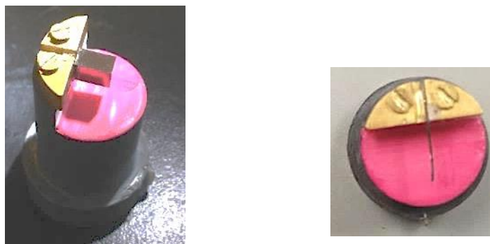
Fig 3.4. Probetas del monocristal Ni-Mn-Ga con distinta geometría (Boise State University).
