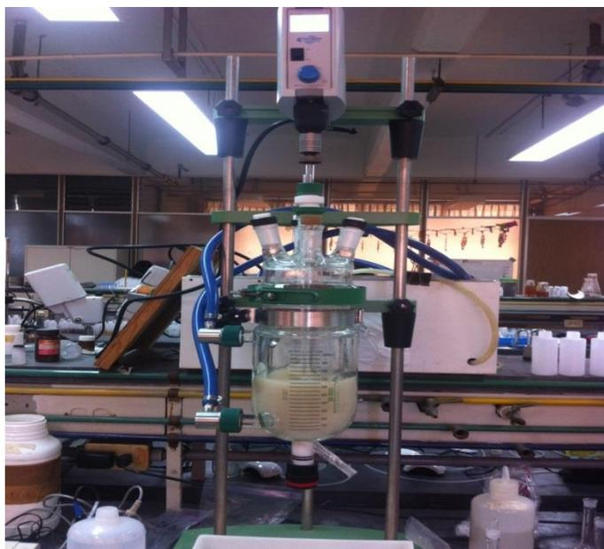
**Figura 5. Dispositivo experimental que consta de un reactor agitado con control de la temperatura y velocidad de agitación.**
