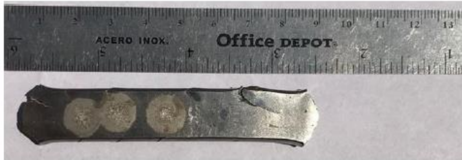
Figura 7. Probeta con la que se realizó el ensayo de espectrometría de emisión atómica.
