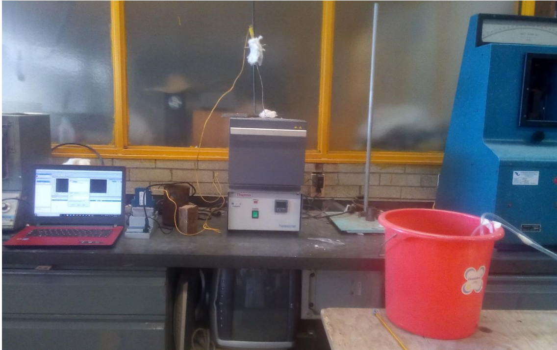
Figura 10. Diseño y Montado del Sistema para realizar el tratamiento térmico de temple.
