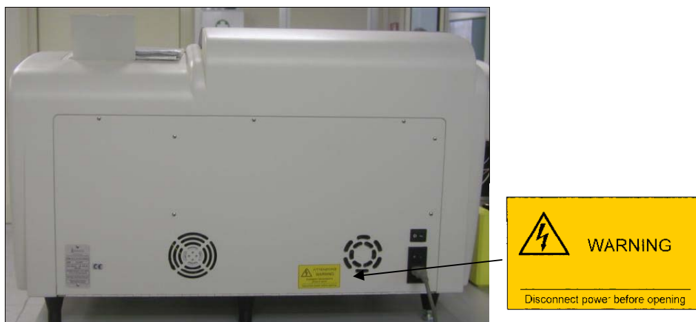
Figura 3. Etiqueta que indica riesgo eléctrico
