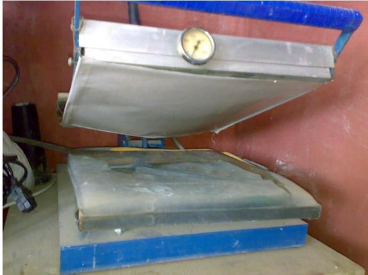
Fig. 1.54 Plancha termo calca
