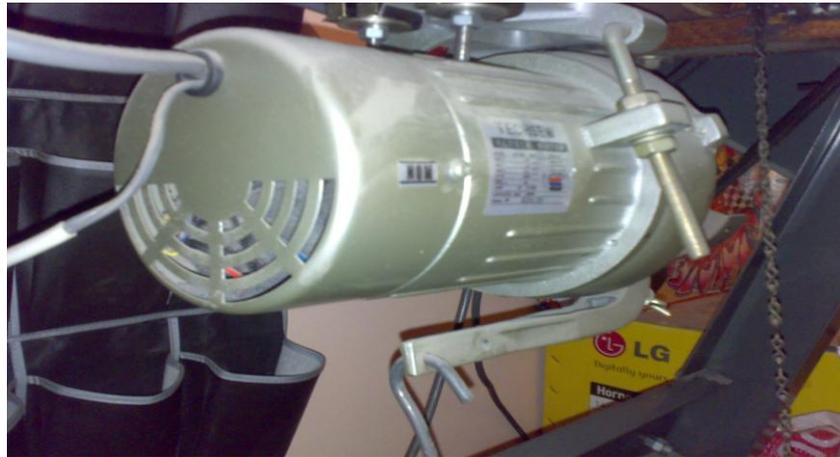
Fig. 1.63 Motor de una maquina overloc
