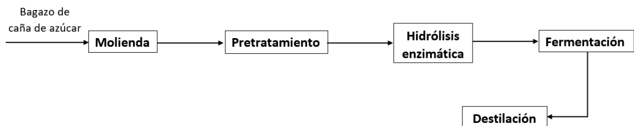
Figura 2-4. Diagrama de producción de bioalcoholes de segunda generación. Fuente: Valdez-Vazquez (2015).
