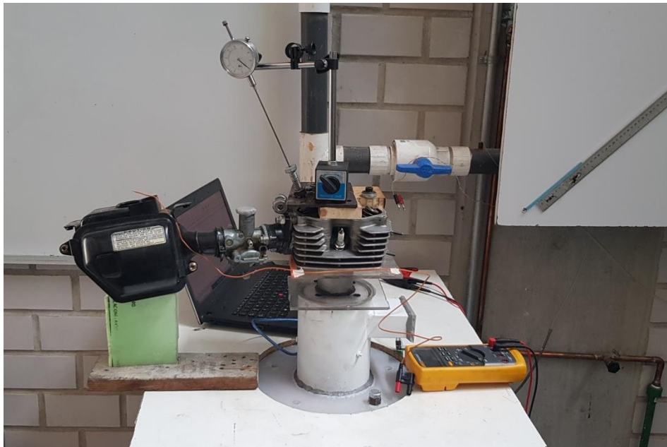
Fig. 5.11 Configuración de ensayos con el sistema de admisión completo del motor Honda CGL 125
