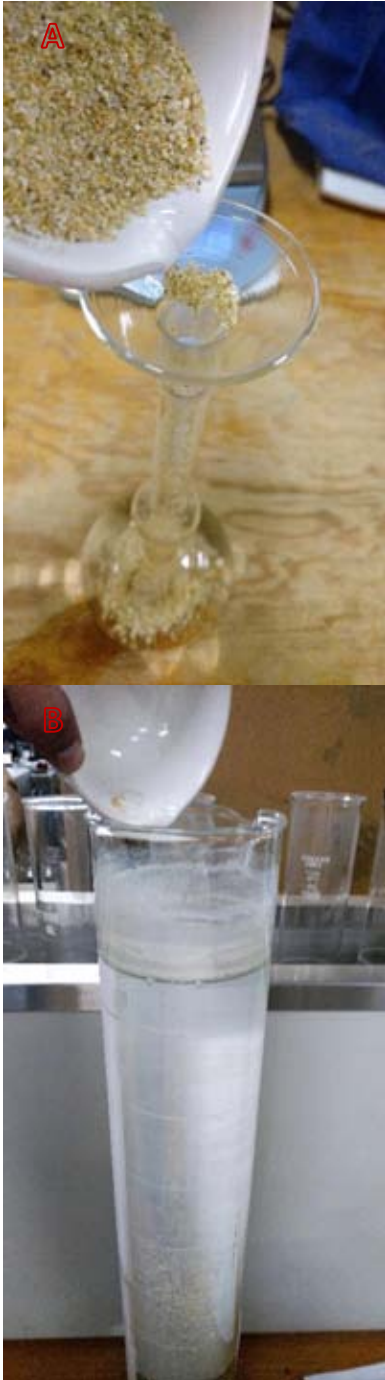
Figura 22. Imágenes donde se ejemplifica el trabajo realizado para obtener datos sobre las características de los sedimentos correspondientes a la Densidad relativa (A) y Velocidad de caída (B).
