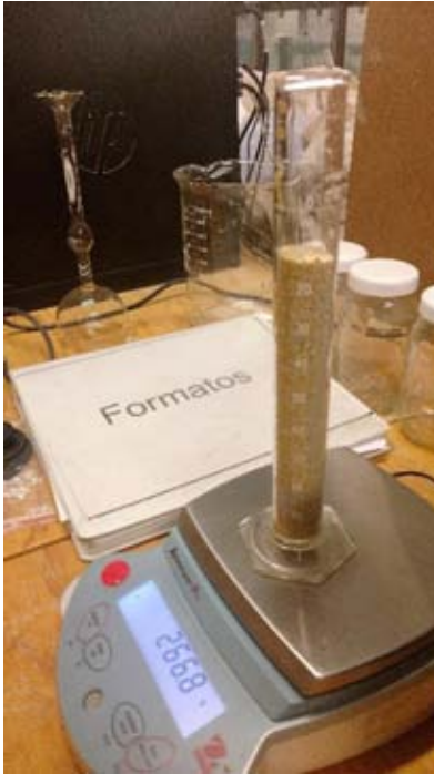
Figura 23. Imagen donde se ejemplifica el trabajo realizado para obtener datos sobre la característica del sedimento correspondiente al Peso Volumétrico.
