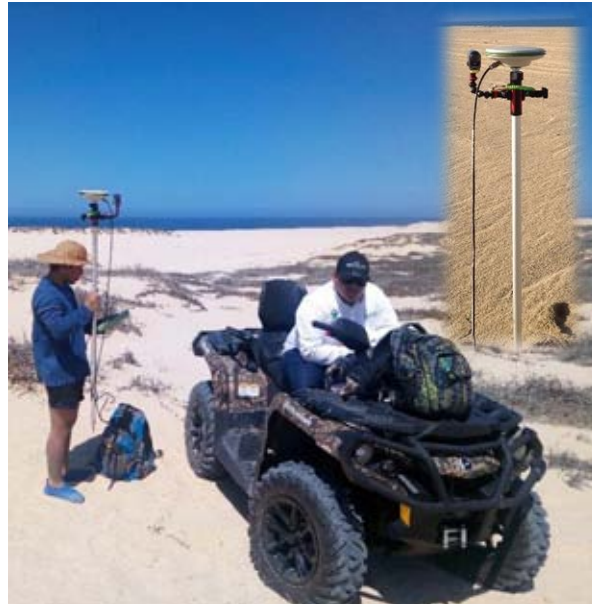
Figura 16. Equipo que se utilizó para el levantamiento de los niveles topográficos. Se observa en la imagen el GPS Diferencial Leica 1200 System® Movil y una ActionCam SONY HDR-AS50®.
