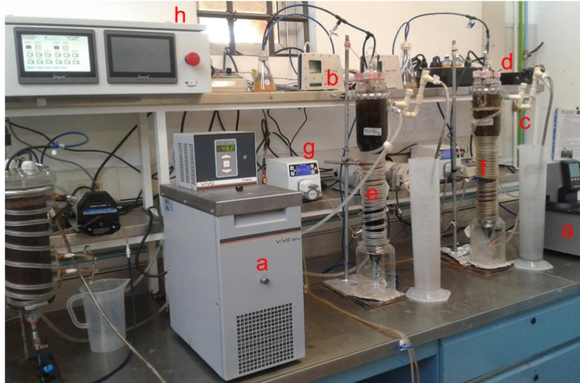
a) Controlador de temperatura, b) Medidor de flujo de biogás, c) Sifón invertido, d) Sensor de CH<sub>4</sub>, e) Reactor UASB mesofílico, f) Reactor UASB termofílico, g) Bomba de recirculación, h) Controlador Lógico Programable (PLC),
