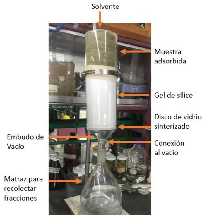
**Figura 9.** Esquema de columna de cromatografía líquida al vacío, montada con muestra vegetal de hojas de pingüica.
