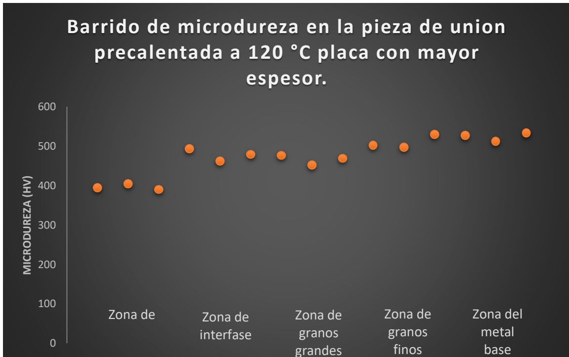
Figura 50. Variación de la microdureza en la pieza de unión precalentada a 120 °C placa con mayor espesor.
