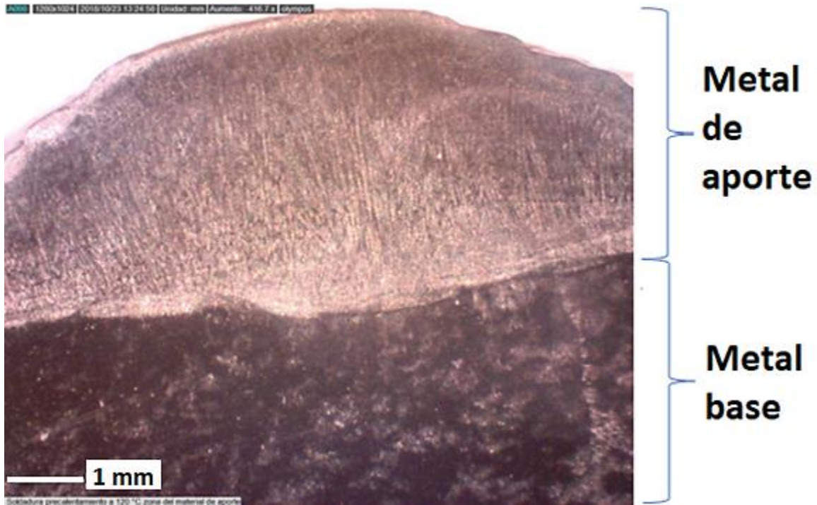
Figura 31. Macroestructura de la pieza precalentada a 120 °C obtenida en el microscopio estereográfico.
