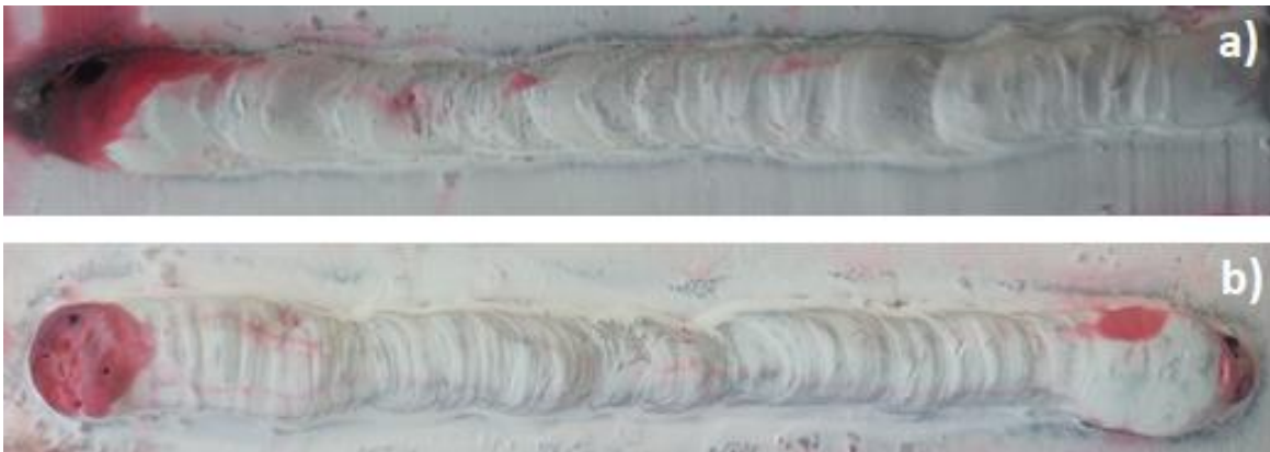
Figura 27. Inspección de dos cordones de soldadura con electrodo E-9018-B3.
