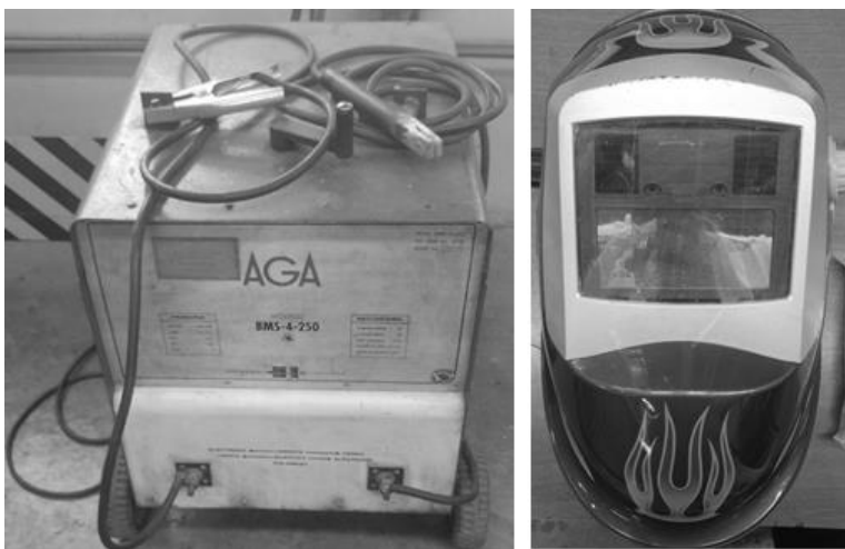
Figura 19. Planta de energía y careta de protección utilizadas para soldar.
