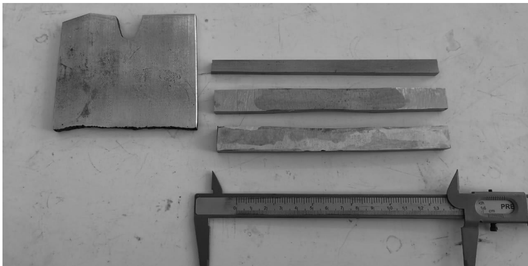
Figura 59. Placa principal y probetas de tensión.
