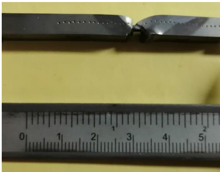
Figura 64. Fractura de la pieza sin precalentamiento en el ensayo de impacto.
