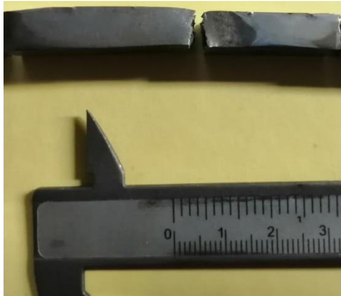
Figura 65. Fractura de la pieza precalentada a 200 °C en el ensayo de impacto.
