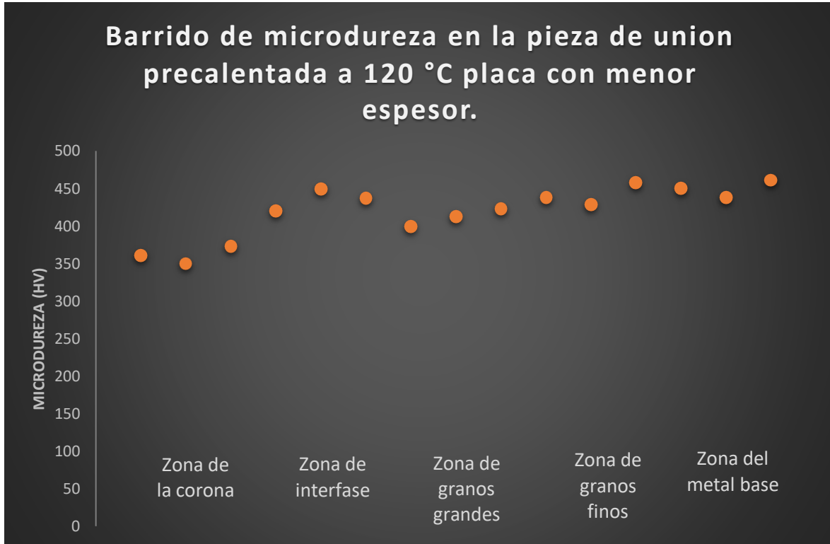
Figura 51. Variación de la microdureza en la pieza de unión precalentada a 120 °C placa con menor espesor.
