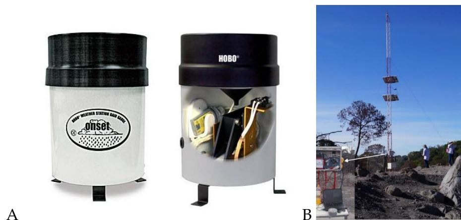
Figura 2.1. a) Estación HOBO que registra la precipitación en la barranca Montegrande. b) Estación de monitoreo ubicada en la sección media de la barranca Montegrande.
