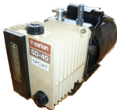
Figura 2.13: Bomba de vacío usada para un experimento con fluorescencia de rayos X.
