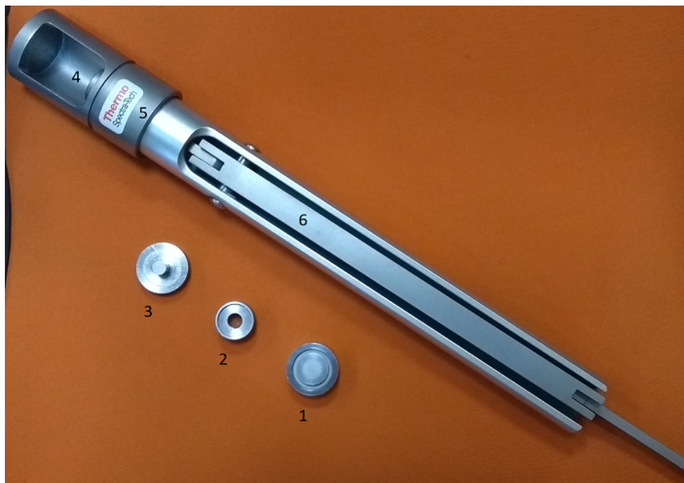
Figura 2.4: Empastilladora manual marca Thermo Spectra-Tech.
