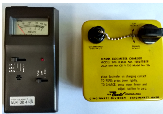
Figura 3.2: Dosímetros utilizados para el experimento de enseñanza de fluorescencia de rayos X.
