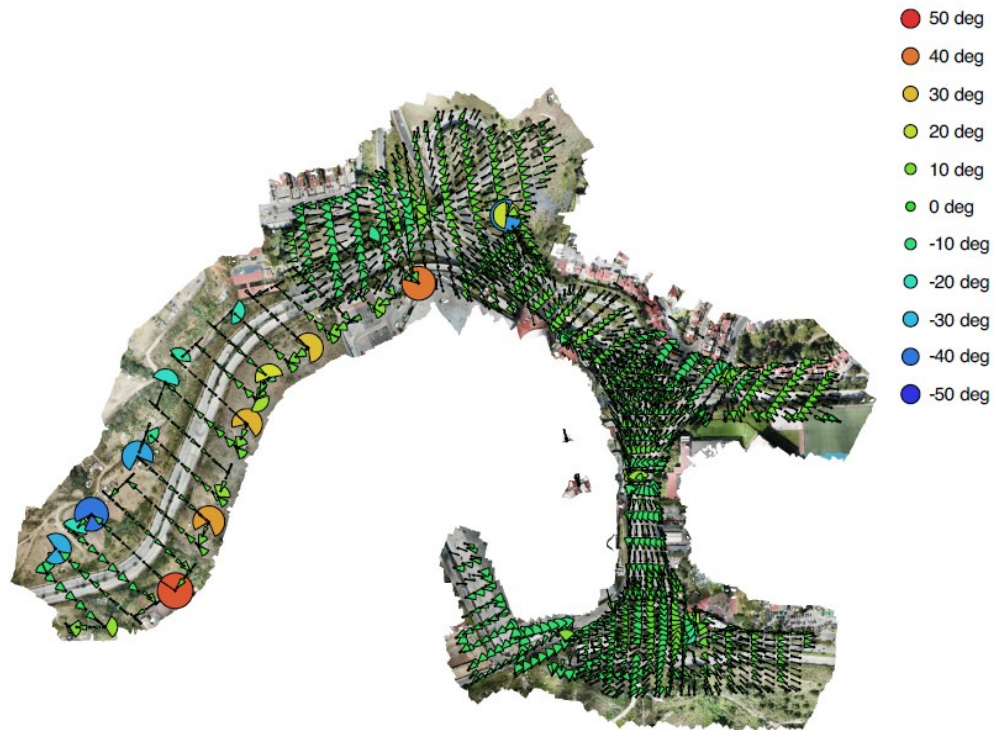
Imagen 9 - Orientación de imágenes y estimación de error (Elaboración propia en Agisoft MetaShape Professional Versión 1.5.1).
