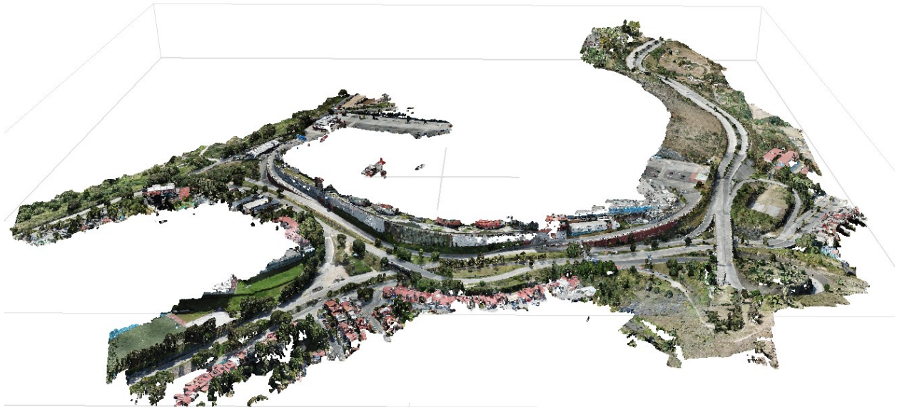
Imagen 13 - Nube de puntos (Elaboración propia en Agisoft MetaShape Professional Versión 1.5.1).
