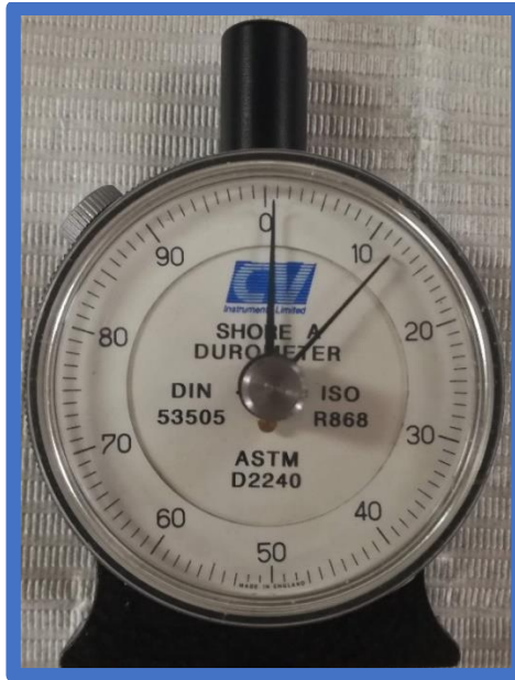
Imagen 10. Durómetro shore A utilizado en el experimento.
