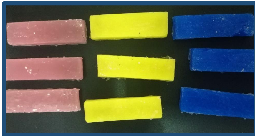
Imagen 6. Obtención de muestras de silicón 24 horas después del prensado.
