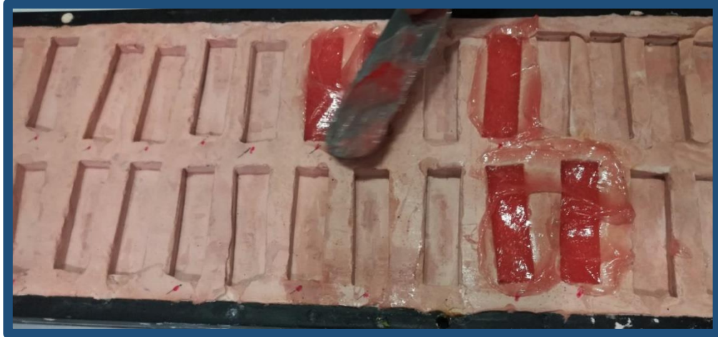
Imagen 5. Colocación del silicón pigmentado en los moldes.
