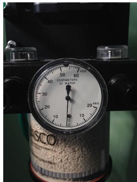
Figura 18 Manómetro (presión de volumen tidal).
