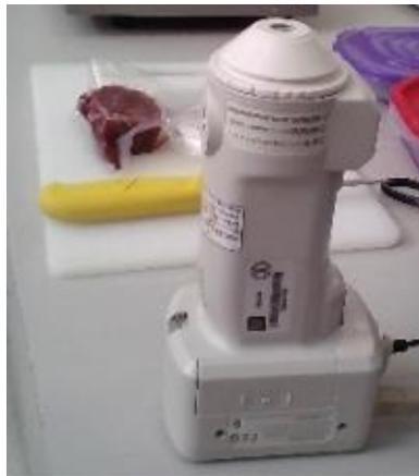
*Figura 22. Espectrofotómetro Konica Minolta CM-600d*
