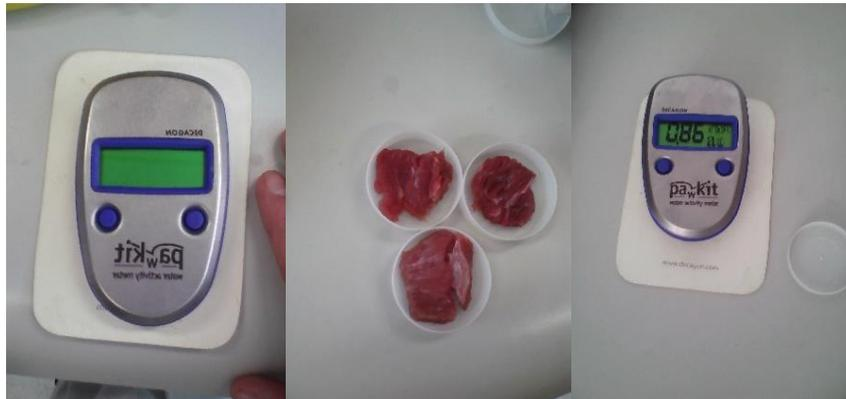
*Figura 26. Determinación de  $a_w$  con higrómetro de punto de rocío Pawkit*
