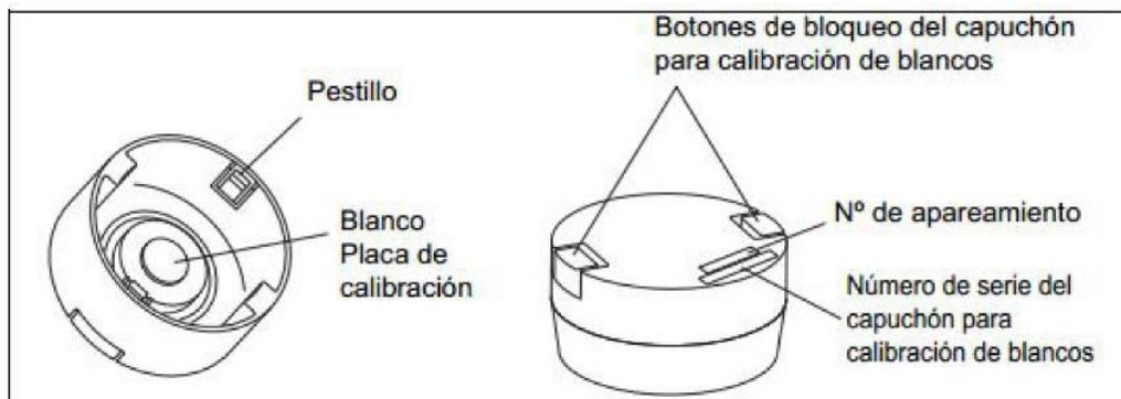
*Figura 23. Capuchón de calibración (Espectrofotómetro Konica Minolta CM-600d)*
