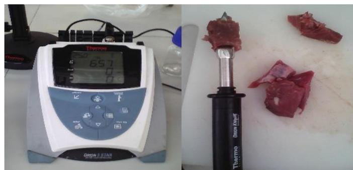
*Figura 25. Medición de pH con potenciómetro Orion Five Star*
