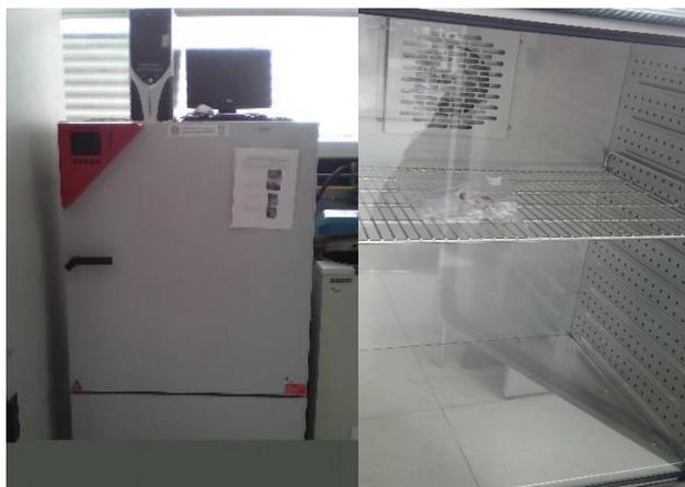
*Figura 15. Cámara climática Binder*
