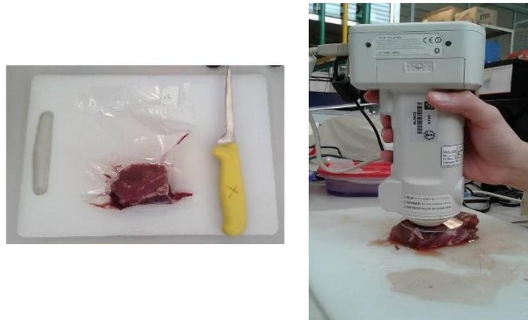
*Figura 24. Medición de los parámetros de perfil de color*
