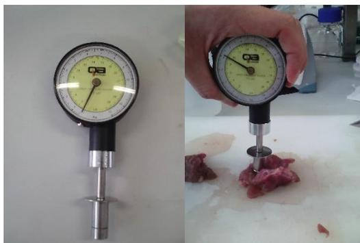
*Figura 27. Medición de dureza con penetrómetro con punta de 11 mm*
