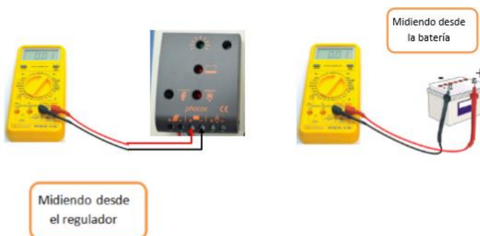
Imagen 15. Medición con multímetro
