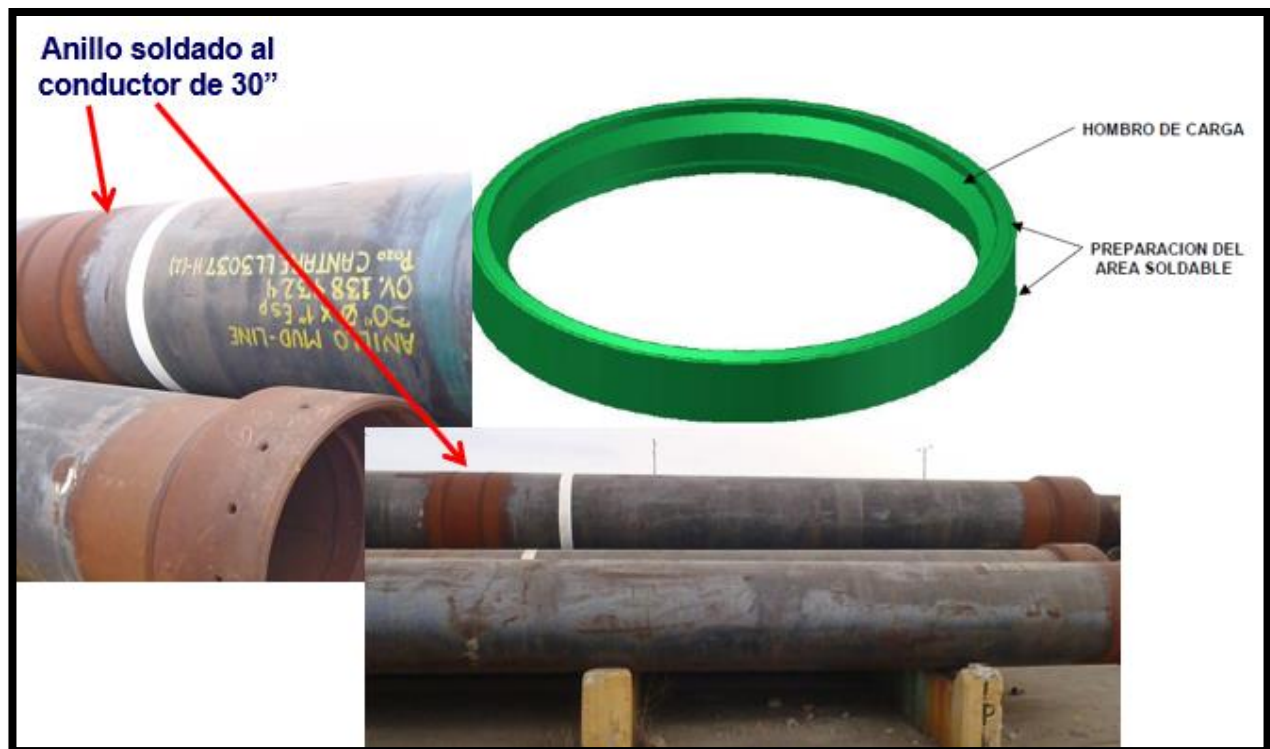
Figura 2.1. Anillo de carga soldado al conductor de 30" Vetco gray (2004)
