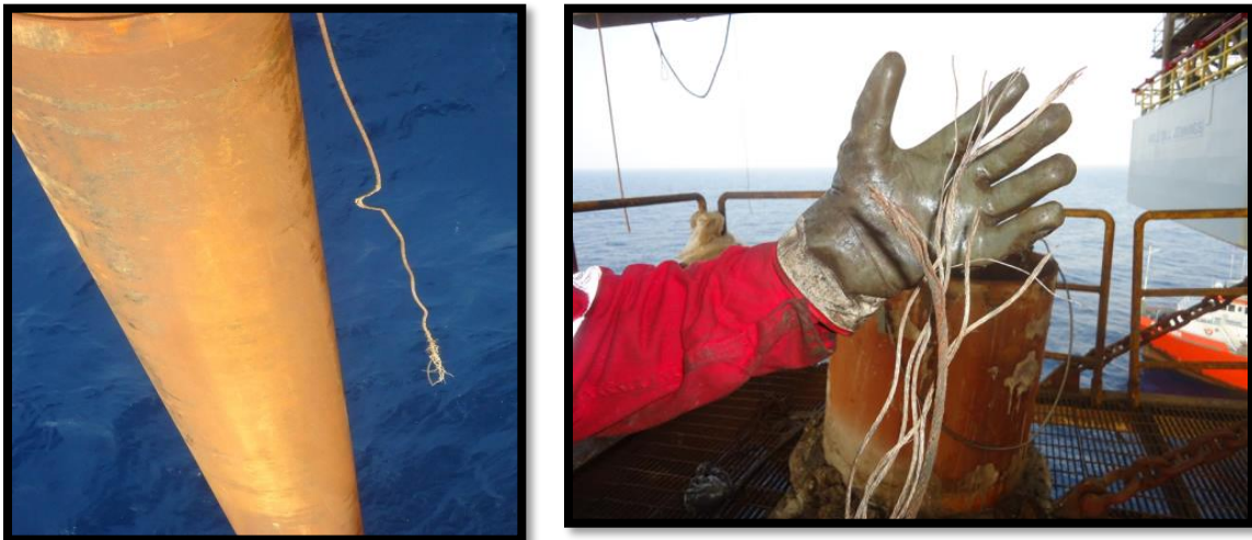
Figura 5.1. Ruptura del cable de recuperación del seguro de conexión Quick jay.
