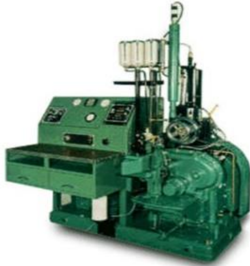
Figura 1.1-6 Motor CFR de la marca Waukesha, usado para medir las propiedades antidetonantes de un combustible.
