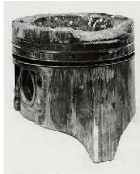
Figura 3.1.2.2-2 Daño producido por la detonación en un pistón.
