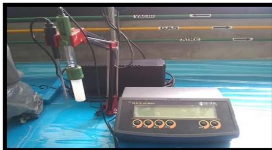
**Ilustración 23.** Equipo de medición de pH 10 HI 2210 pH Meter HANNA Instruments.
