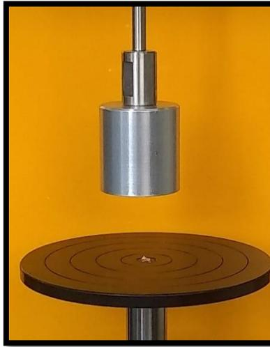
**Ilustración 31.** Prueba de dureza de las microagujas.
