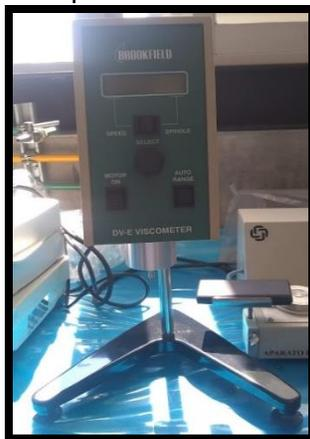
**Ilustración 24.** Viscosímetro DV-E Brookfield
