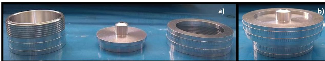
**Ilustración 25.** a) Partes del picnómetro, b) Picnómetro ensamblado.
