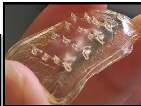
**Ilustración 36.** Microagujas poliméricas biodegradables huecas, a) vista frontal. b) vista superior.
