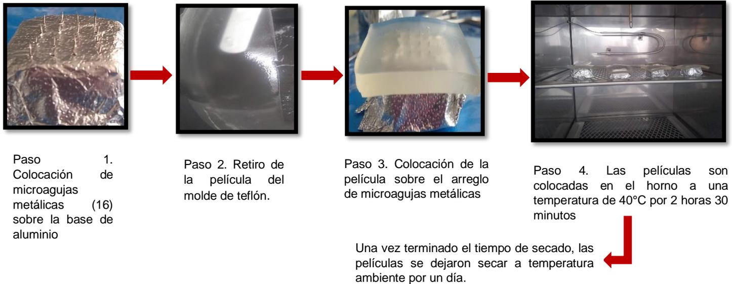
**Ilustración 30.** Esquema del proceso de manufactura utilizado para la manufactura de las microagujas poliméricas huecas.
