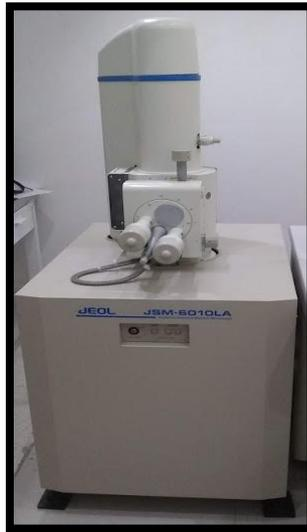
**Ilustración 34.** Microscopio electrónico de barrido JMS-6010LA InToucheScope.
