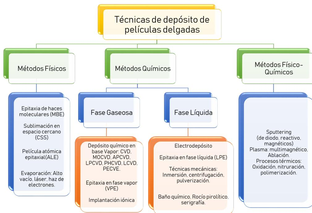
Figura 3.1: Clasificación de las técnicas de depósito de película delgada.
