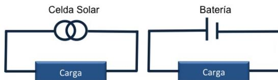
Figura 1.6: La celda solar puede reemplazar una batería.
