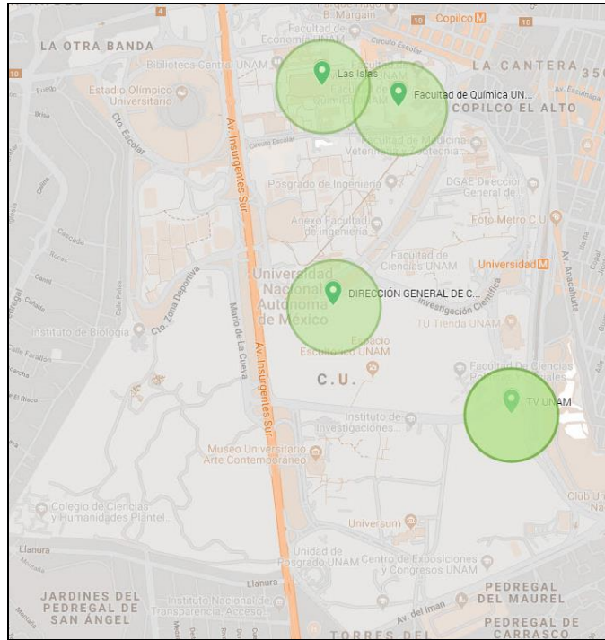
Figure 39. Representación del radio de cobertura de 500 m para solución dada por el modelo de máxima cobertura para cuatro ambulancias. (Fuente: Elaboración propia, 2019).
