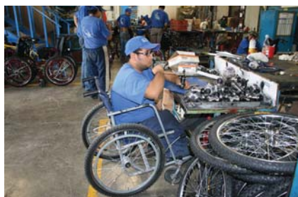
Imagen 38. Puesto de trabajo que no cumple con las necesidades morfológicas del usuario. Mesa alta y profunda.
