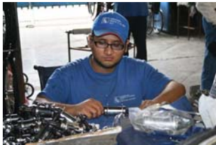
Imagen 30. Altura de la mesa no adecuada.
