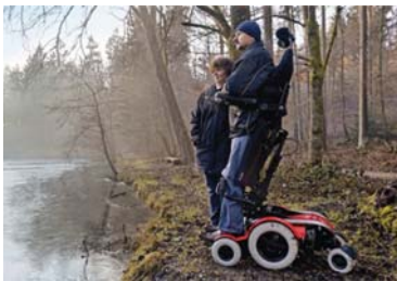
Imagen 15. Silla de ruedas bipedestadora, permite las personas se puedan levantar y realizar otro tipo de actividades, diseñada por MDA. https://www.mda.org/quest/article/stand-and-go-mobile-standers-and-standing-wheelchairs
