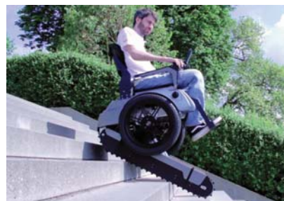
Imagen 19. Prototipo de silla salvaescaleras desarrollado por el Instituto Federal Suizo de Tecnología. Foto: http://www.losandes.com.ar/files/image/15/06/image5578a98d4441d9.82205812.jpg
