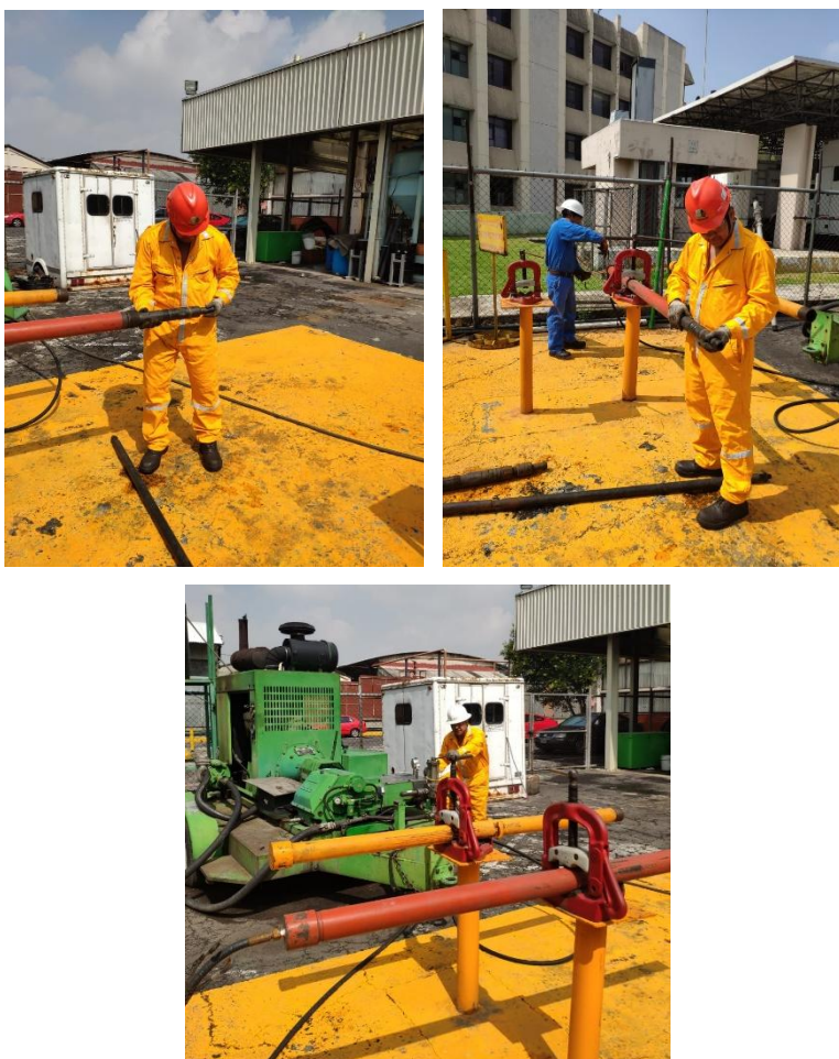
Figura 4.15 Pruebas de hermeticidad del MPFV®
