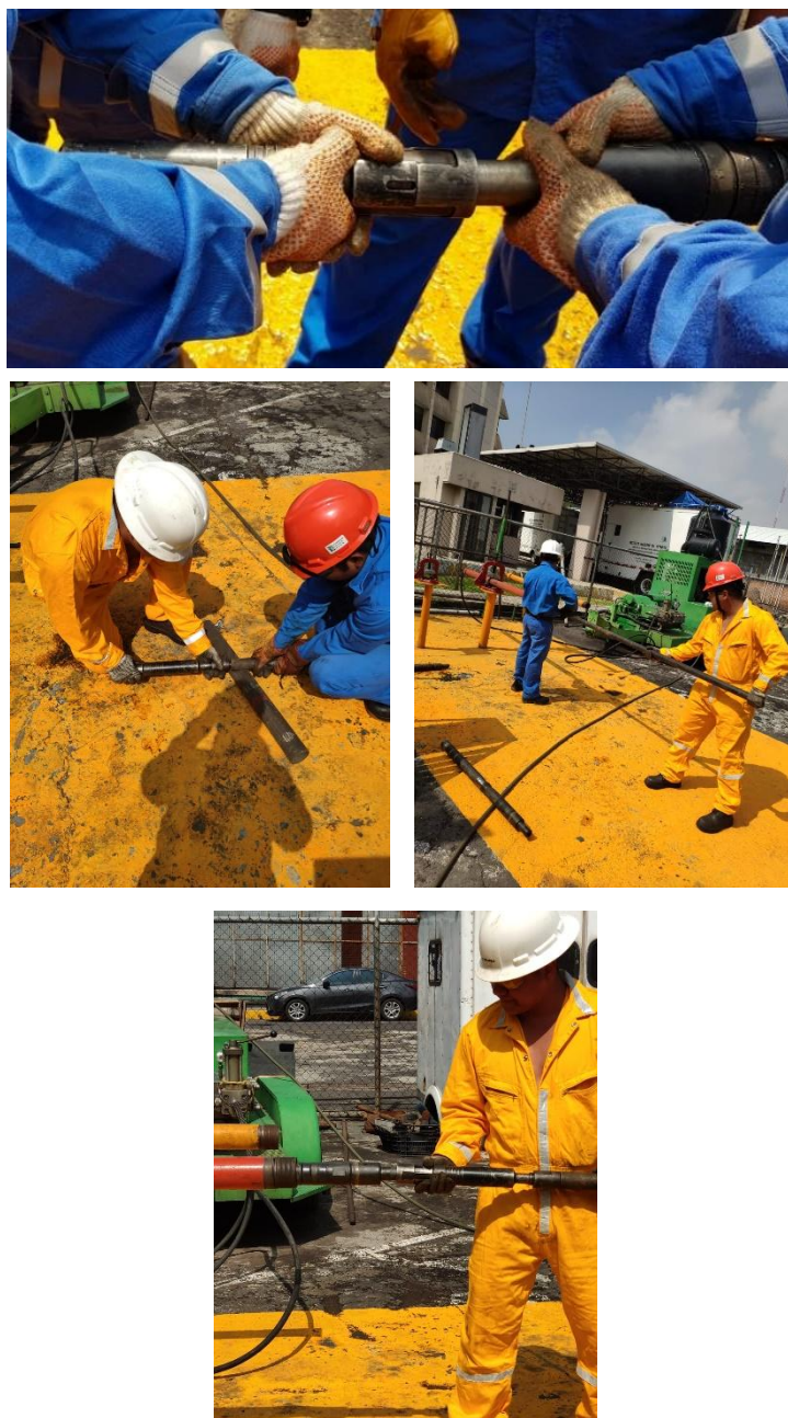
Figura 4.16 Pruebas de anclaje y desanclaje del MPFV®
