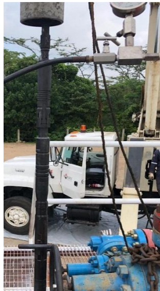
Figura 4.19 Herramienta MPFV® de 18/64" acoplada al pescante JDC
