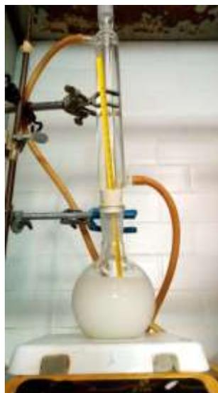
**Figura A.2.2.** Equipo de reflujo para elaboración del disolvente MAC-141©
