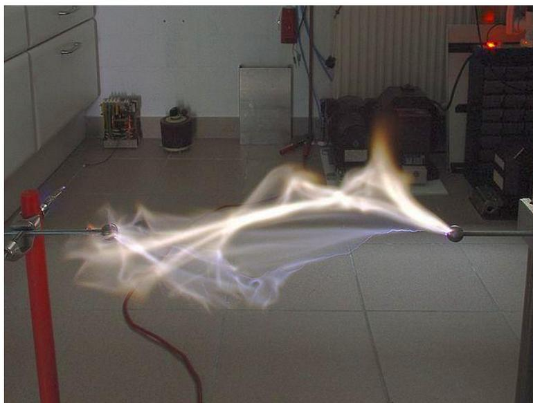
Figura 3.3. Conducción eléctrica entre dos electrodos esféricos de acero ( $d = 15 \text{ mm}$ ) debido a la ionización del aire – Imagen recuperada de [Pérez Formigó, M. (2010), p. 15].
