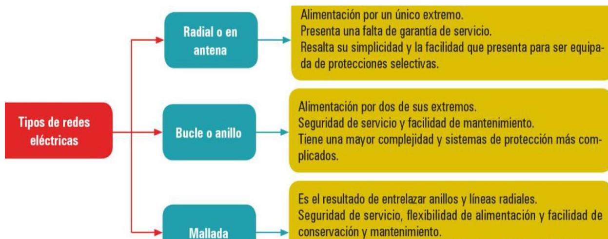
Figura 1.14. Características de los diferentes tipos de redes eléctricas – Imagen recuperada de [Trashorras Montcelos, J., p. 5].
