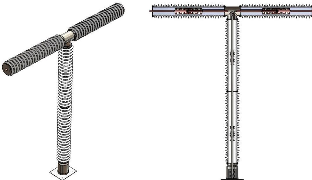
Figura 4.7. Concepto de un VCB a 245 kV – Imagen recuperada de [Falkingham, L. T., Cheng, K. W. & Molan, W. J. (2016), p. 1-2].
