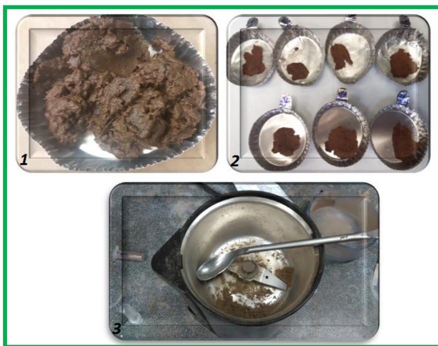
**Figura 26:** Extrudado (1), extrudado seco (2) y triturador (3) del bagazo de agave.
