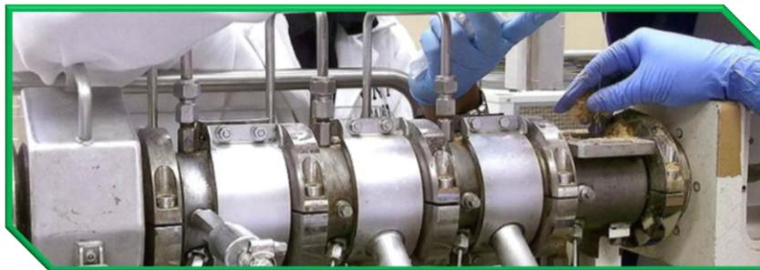
**Figura 24:** Extrusor de doble tornillo.
