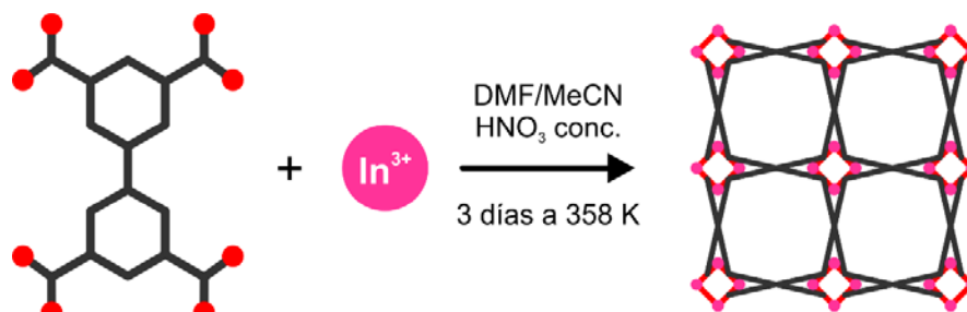
Figura 2.2. Síntesis del InOF-1, a partir de nitrato de indio(III) y ácido bifenil-3,3',5,5'-tetracarboxílico.
