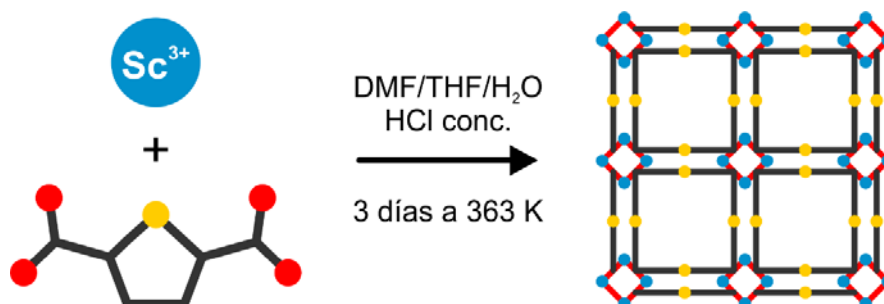
Figura 2.1. Síntesis del NOTT-401, partiendo del trifluorometanosulfonato de escandio (III) y el ácido tiofen-2,5-dicarboxílico.
