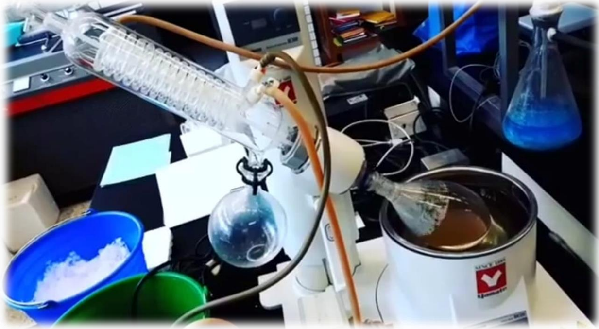
Figura 11. Extracto acuoso de Arctostaphylos pungens evaporado a presión reducida en Rota vapor
