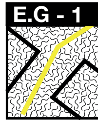
E.G - 1 Grieta con salida a colonia Cama de material flexible
