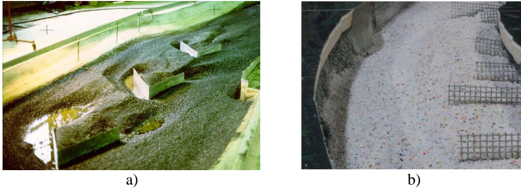
Figura 2.16 Estructura de protección en modelos de ríos: a) Diques de lámina metálica en el modelo de fondo móvil convencional St. Louis Harbor y b) Espigones de malla de alambre galvanizado en un micromodelo. Fuente: Davinroy et al., 2011
