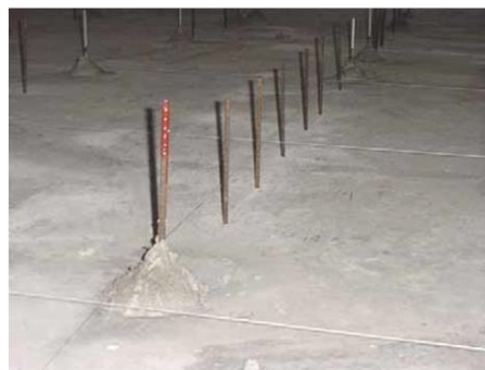
Figura 2.18 Varillas para configurar el fondo de manera predeterminada en un modelo hidráulico convencional del río Carrizal. Fuente: Ortiz, 2005
