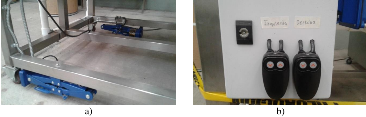
Figura 4.3 a) Gatos eléctricos y b) Controladores de los gatos eléctricos
