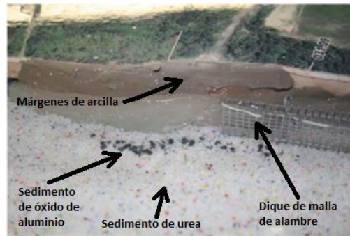
Figura 2.15 Materiales empleados comúnmente para representar las fronteras del micromodelo. Fuente: Davinroy et al., 2011
