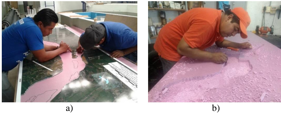
Figura 3.6 a) Trazo de las fronteras del río en la placa de poliestireno y b) Corte de la placa de poliestireno para dar forma a la cubeta del río
