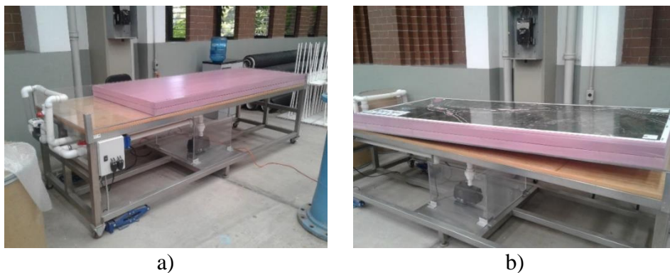
Figura 3.7 a) Placa de poliestireno cortada a lo ancho para ajustarla a la caja de poliestireno y b) Placa de poliestireno sobrepuesta en la mesa de modelación
