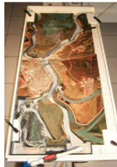
Figura 2.2 a) Modelo convencional de fondo móvil Dogtooth Bend, escala horizontal 1:400, escala vertical 1:100; y b) Micromodelo Atchafalaya River, escala horizontal 1:7200, escala vertical 1:1200. Fuente: Davinroy et al., 2011
