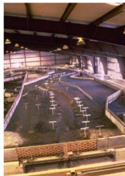
Figura 2.2 a) Modelo convencional de fondo móvil Dogtooth Bend, escala horizontal 1:400, escala vertical 1:100; y b) Micromodelo Atchafalaya River, escala horizontal 1:7200, escala vertical 1:1200. Fuente: Davinroy et al., 2011
