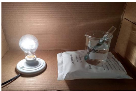
Figura 20. Forma de montar el sistema para determinar acción de la temperatura.
