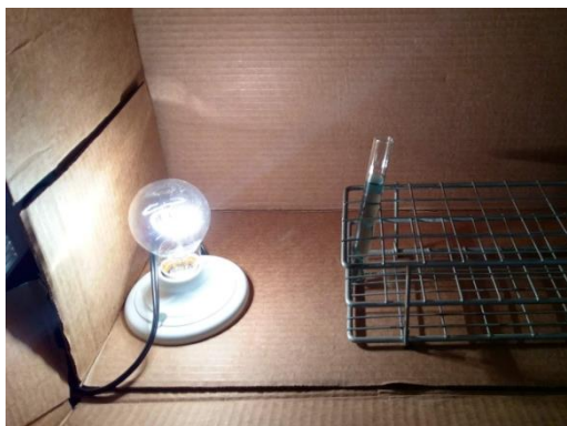
Figura 19. Forma de montar el sistema para determinar acción de la intensidad de la luz.
