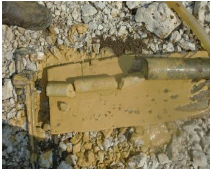
Avance y recuperación de muestra con broca de diamante y barril doble, norma: ASTM-D-1586-2008
