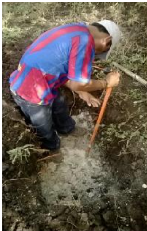
Recuperación de muestra alterada para determinar el contenido de agua.
