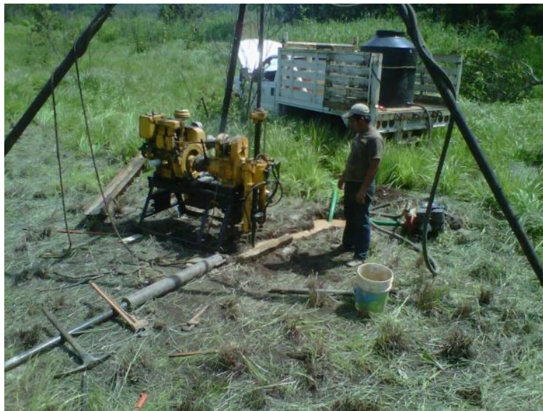
Avance y recuperación de muestra de suelo con broca de diamante y barril recuperador.
