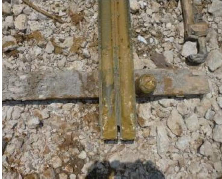
Realización de prueba de penetración estándar, norma: ASTM-D-1586-2008
