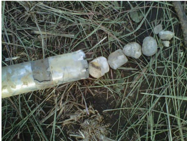
Recuperación de muestra alterada
