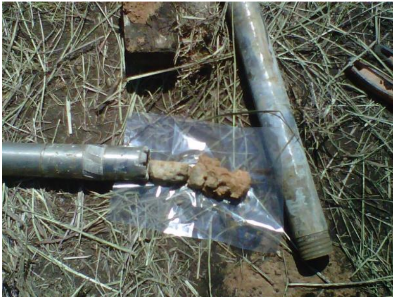
Recuperación de muestra alterada.
