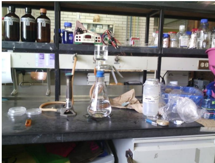
Figura 10. Filtración de las muestras de agua de piscina por la técnica de Filtro de Membrana.
