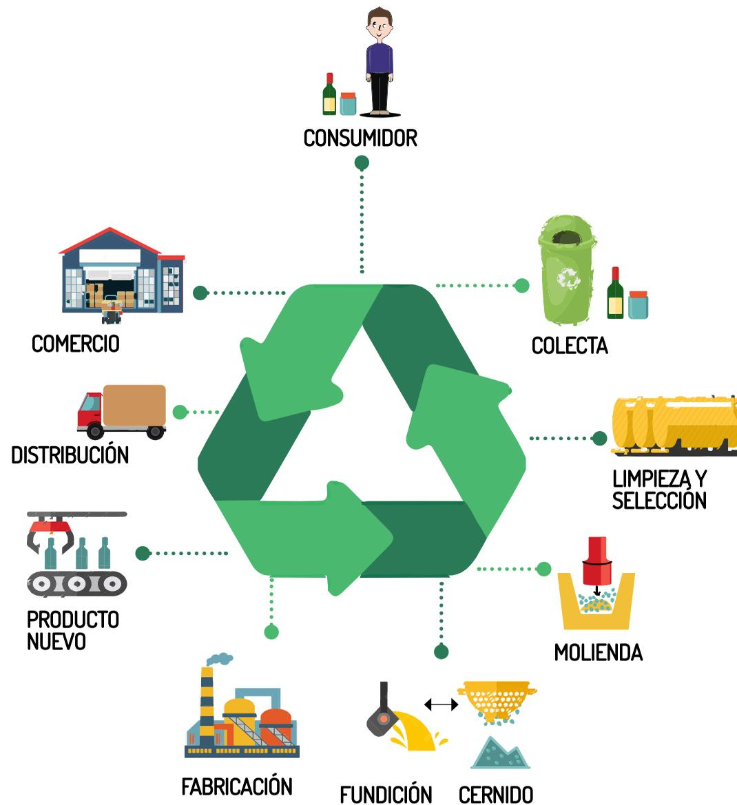
El primer paso consiste en limpiar el vidrio, es así como se retiran los materiales externos que puedan llevar adheridos los vidrios (siliconas, restos de carpinterías, plásticos, etc.). Una vez limpio de impurezas pasa por un conjunto de tamices y martillos, en los que se va moliendo hasta alcanzar la granulometría necesaria.
