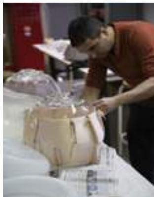
Molde en material textil fabricado a base de fibras, tipo E con un tratamiento de caucho.
