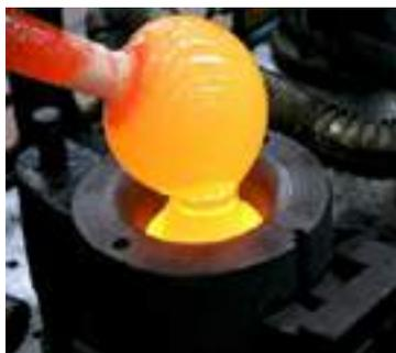
Es el material más utilizado. Al ser liviano, resistente a la deformación y la cocción. Adecuado para moldear fuera del mismo molde. Si el moldeado es interno es necesario de caolin para desmoldar la pieza.
