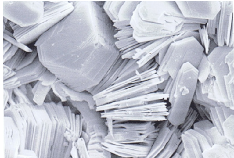
Fig. 94. Partículas de arcilla vistas con el microscopio electrónico. (Fuente: Fontaine y Anger, 2009, p. 151)
