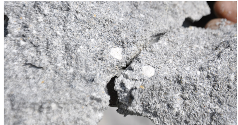
Figs. 62 y 63. Residuos del proceso de calcinación de la roca caliza, llamado en la localidad excedente de cal. En la imagen 62 puede observarse la capa exterior que ha endurecido, producto de la carbonatación al estar en contacto con el aire. Los puntos blancos que se observan en la imagen 63 son las partículas de óxido e hidróxido de calcio presentes en el remanente. (Fotografías: Acervo del LABPySCT)
