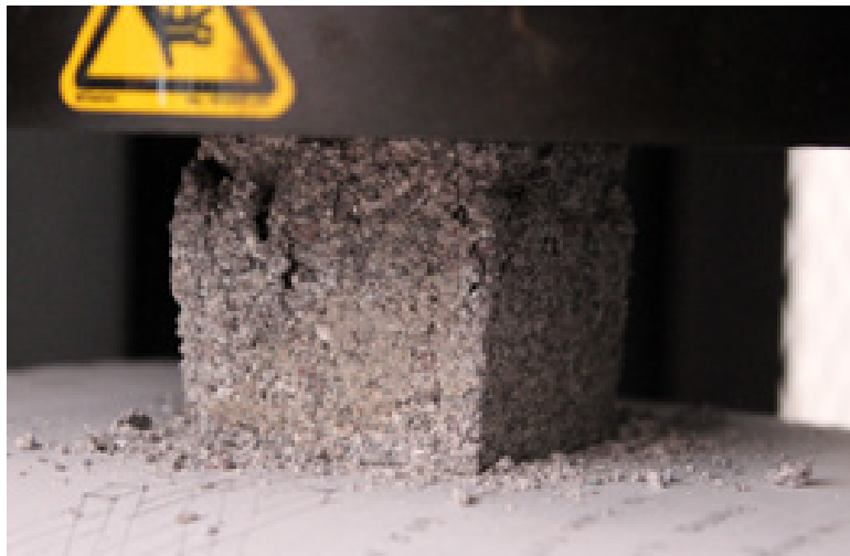
Figs. 135 y 136. Mezcla E-6, prueba en Laboratorios de edificación sustentable. (Fotografías: acervo del LABPySCT).
