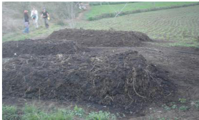
Figs. 90 y 91. Capas de tierra. En la imagen 90 puede apreciarse la capa superficial de tierra negra o humus, no apta para construir. En la imagen 91 se muestra la capa arcillosa, materia prima ideal para la construcción con tierra. (Fotografías: Ángeles Vizcarra).
