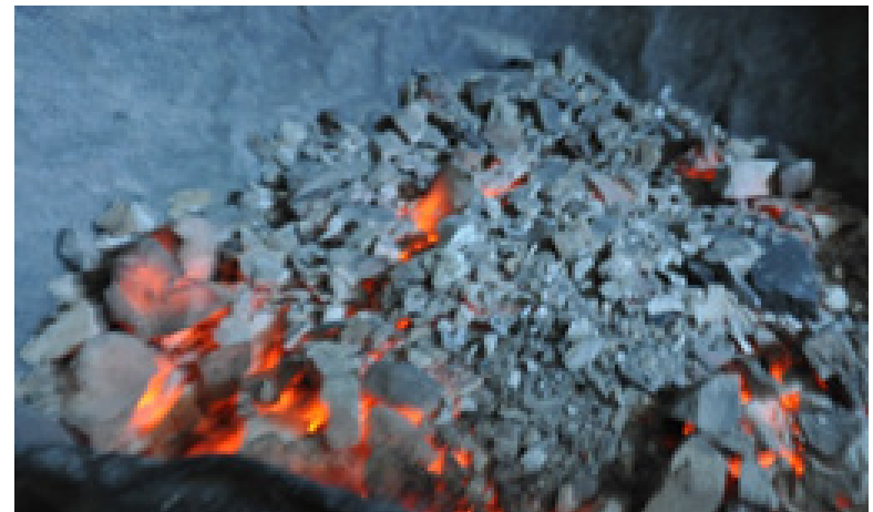
Figs. 96 y 97. Proceso de calcinación de roca caliza y cal viva recién salida del horno en la calera de Tepeyahualco. (Fotografías: acervo del LABPySCT)
