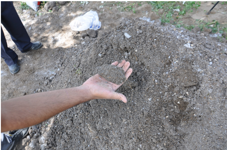
Fig. 76. Materiales mezclados con el grado exacto de humedad. (Fotografía: acervo del LABPySCT)
