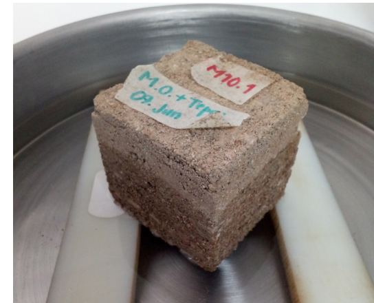
Figura 152. Prueba de absorción capilar de mezclas que contienen cal y puzolanas. (Fotografía: acervo del LABPySCT).
