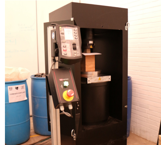
Figura 113. Máquina de compresión marca Instron modelo 400 RD con capacidad de carga de 100 ton (Fotografía: acervo del LABPySCT)
