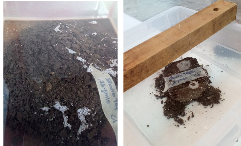
Figs. 155 y 156. Ejemplo de una prueba de absorción capilar de probetas de barro. Obsérvese la rápida absorción capilar, la probeta se desintegró antes de terminar la prueba (Fotografías: acervo del LABPySCT).
