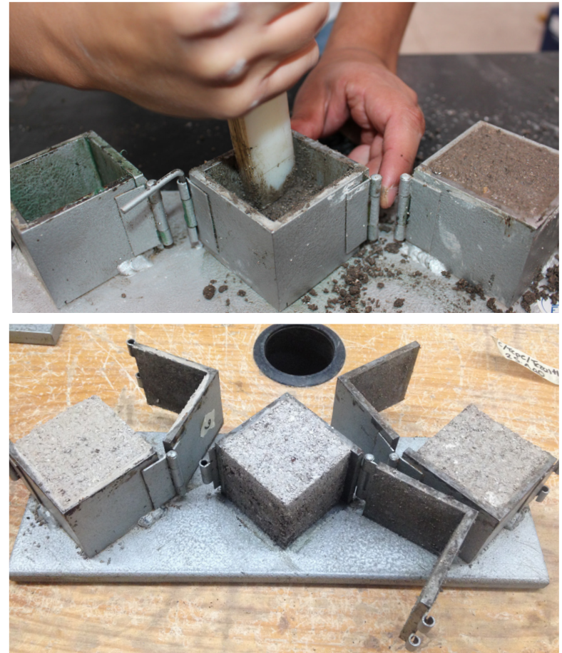
Fig. 111 y 112. Procedimiento de apisonado de la mezcla en los moldes de acero maquinado, y muestras semi-secas listas para ser desmoldadas (Fotografías: acervo del LABPySCT)
