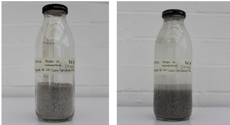
Figs. 107 y 108. Prueba de sedimentación del excedente de cal para determinar la cantidad de hidróxido de calcio y arenas de roca caliza que no alcanzó a calcinarse. En la imagen 119 se aprecia el material residual en seco, y en la siguiente, al agregarle agua se aprecia en la parte superior de la botella la cantidad de hidróxido de calcio y en la inferior, las arenas de la roca caliza que no alcanzó a calcinarse. (Fotografías: acervo del LABPySCT)
