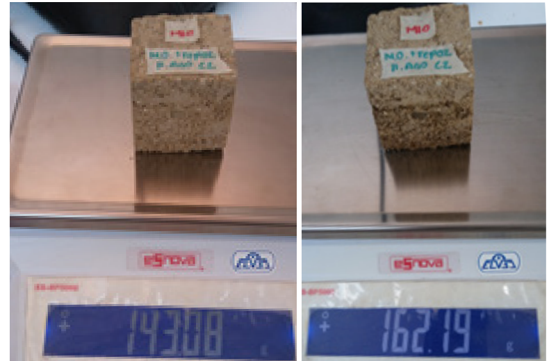
Figs. 150 y 151. Pesado de la probeta antes y después de la prueba de inmersión parcial (Fotografías: acervo del LABPySCT).
