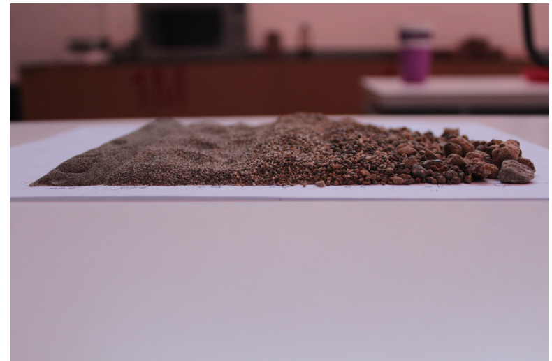
Figs. 92 y 93. Granulometría de tierras analizadas en el LABPySCT, donde pueden apreciarse las gravas, arenas y limos. (Fotografías: acervo del LABPySCT)
