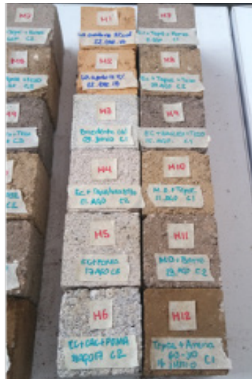
Fig. 149. Preparación de probetas para pruebas de absorción capilar (Fotografías: acervo del LABPySCT).
