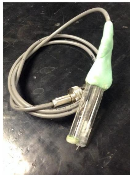
**Fotografía 8.** Microelectrodo ya ensamblado y encapsulado con resina epóxica.
