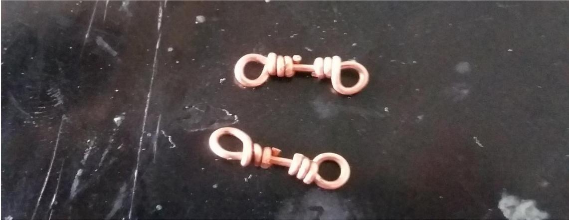
**Fotografía 6.** Terminales diseñadas para la sujeción del microelectrodo al cable coaxial.
