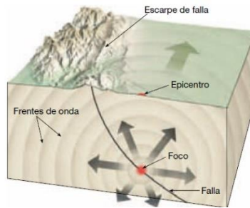
Figura 52. Origen de un sismo y sus componentes. Tomado de Tarbuck y Lutgens, 2005.
