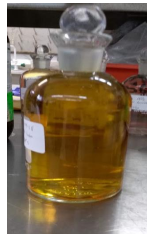
Figura 5.4. Winkler con H 2 SO 4 concentrado
