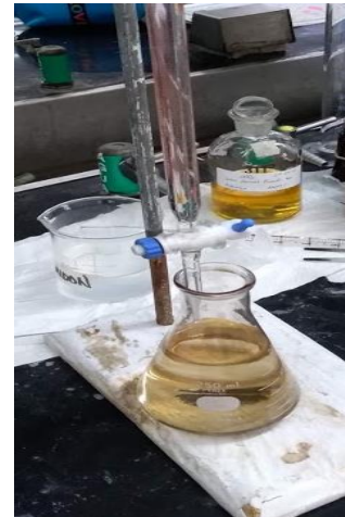
Figura 5.7. Titulación con tiosulfato
