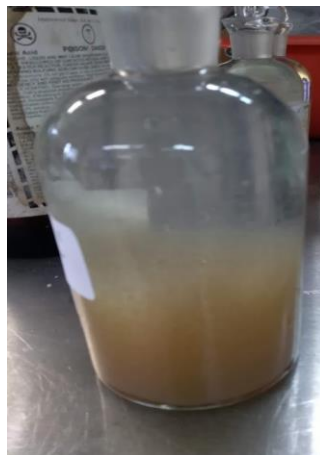
Figura 5.3. Winkler con sulfato de manganeso y yoduro alcalino de azida
