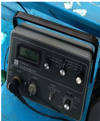
Figura 3.7. Medidor de oxígeno
