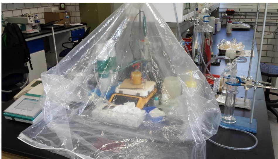
Figura 8. Cámara de atmósfera inerte optimizada para titulaciones potenciométricas de minerales.
