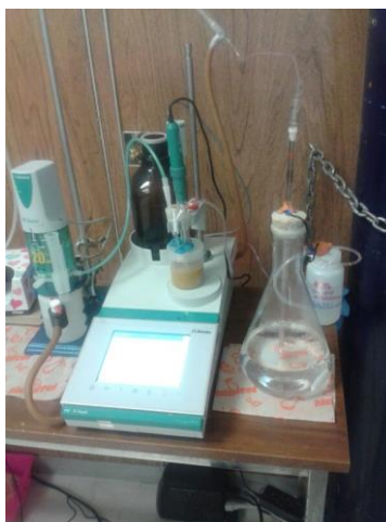
Figura 7. Equipo Metrohm 916 Ti Touch acoplado a una línea de nitrógeno para realizar titulaciones de goetitas de diferentes ASE.
