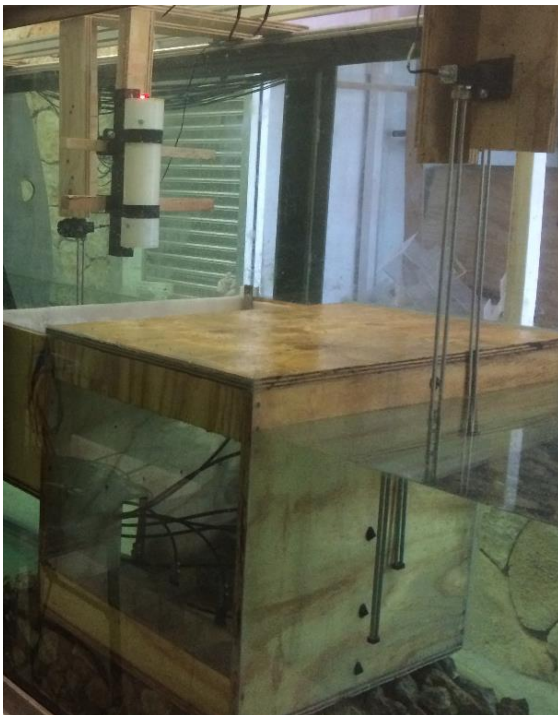
Figura 33. Colocación de sensor de nivel acústico
