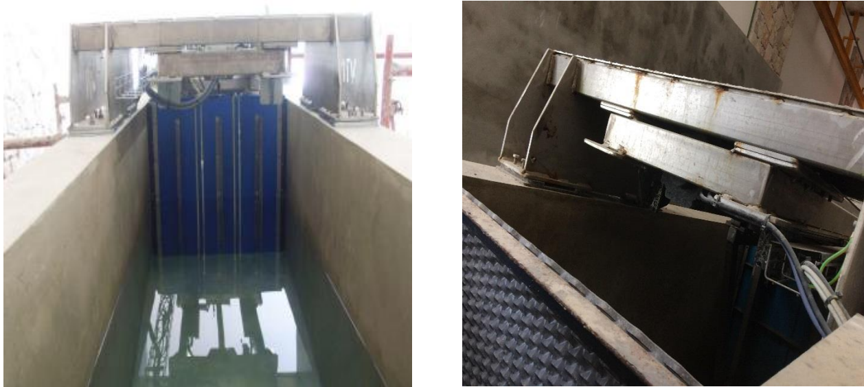
Figura 16. Estructura de sustentación del pistón - pala generadora.
