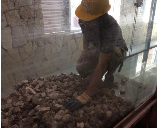
Figura 25. Elaboración de la banqueta del dique vertical a 17 metros
