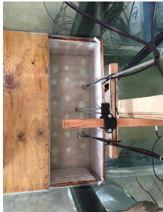
Figura 34. Colocación de sensor de nivel tipo resistivo y sensor de presión
