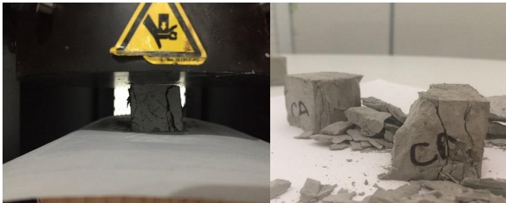
Imagen 19. Probeta de pasta de cemento durante el proceso de prueba y después de la prueba.
