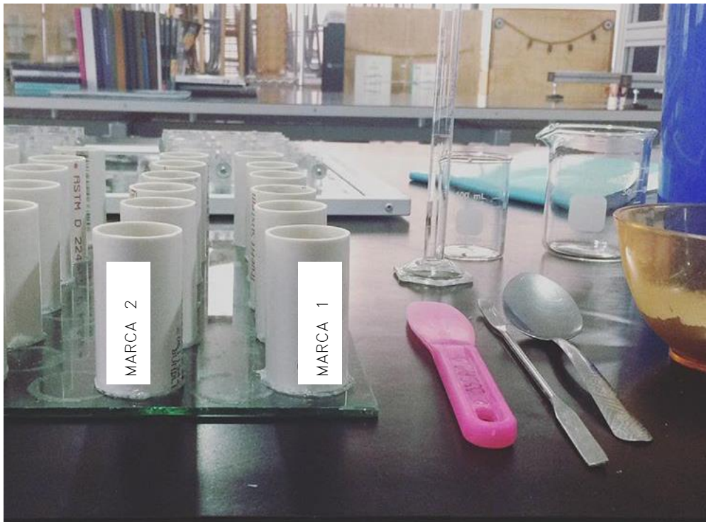
Imagen 7. Elaboración de mezcla de pasta de cemento para conocer la trabajabilidad de cada marca de cemento.
