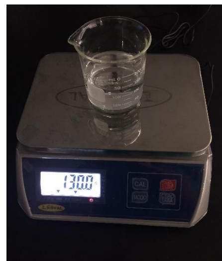
Imagen 10. Pesaje de agua para realizar las mezclas de pastas.
